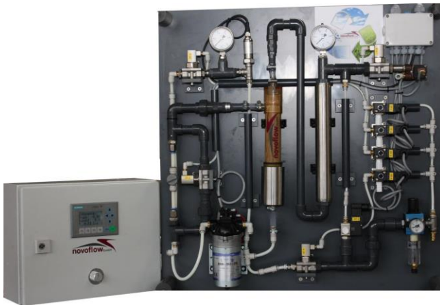
Abbildung 21: Dead-End-UF-Anlage im Labormaßstab (Fa. Wehrle)
