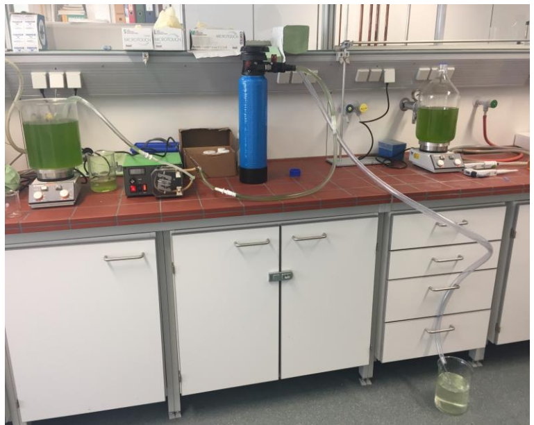
Abbildung 31: Laboranlage für die Flockungfiltrationsversuche
