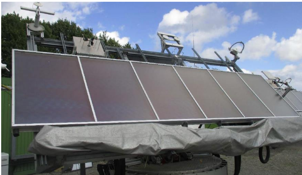
Abbildung 13: „Sechsscheiber“-Kollektorprototyp „Fera 803-ITO“ während der Leistungsmessung auf dem ISFH-Nachführstand.
