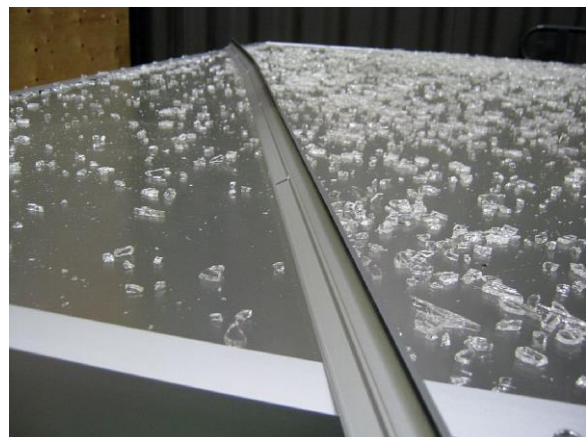
Abbildung 17: „Zweiseiber“-Kollektorprototyp während des Sogtests bei SOLVIS (links) und Scheibenbruch nach einer Belastung von 1940 Pa (rechts).
