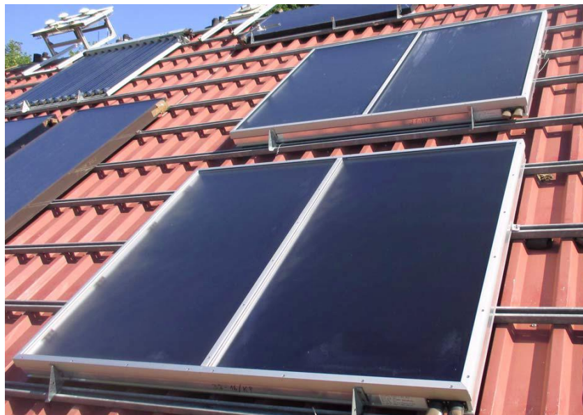
Abbildung 19: „Zweischeiber“-Kollektorprototypen während der Exposition auf dem Testdach des ISFH (oben: gasdichter Kollektor „Fera283-33V“; unten: Kollektor mit durchlüfteter Verglasung „Fera283-230“)
