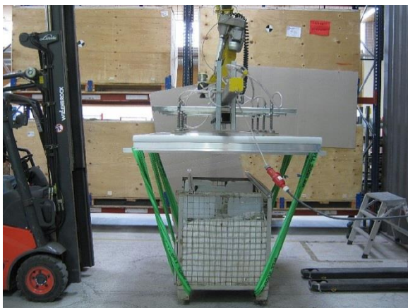
Abbildung 17: „Zweiseiber“-Kollektorprototyp während des Sogtests bei SOLVIS (links) und Scheibenbruch nach einer Belastung von 1940 Pa (rechts).
