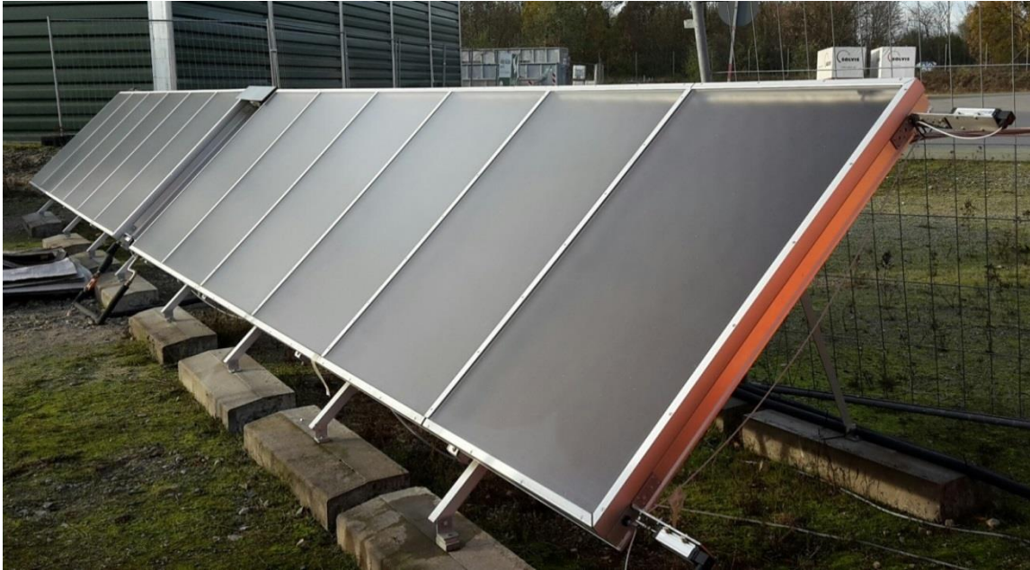
Abbildung 18: Zwei „Sechsscheiber“-Kollektorprototypen während der zyklischen Hochtemperaturbelastung auf dem Solvis-Außengelände.
