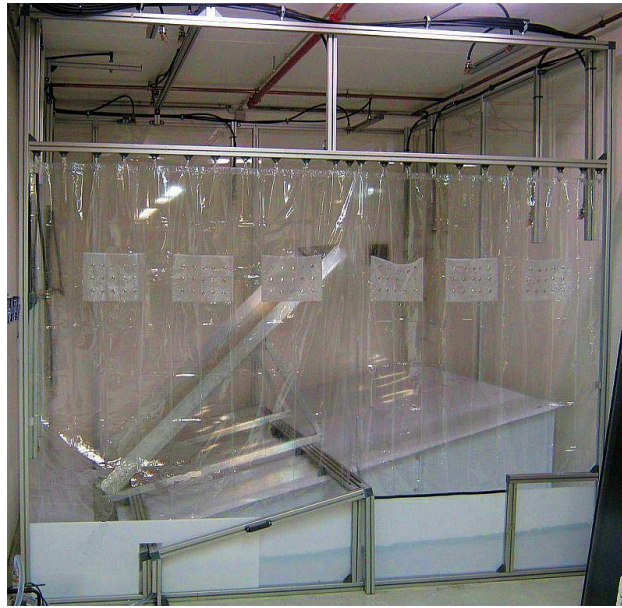
Abbildung 16: Zweiseiber-Kollektorprototypen während des Beregnungstests bei SOLVIS.
