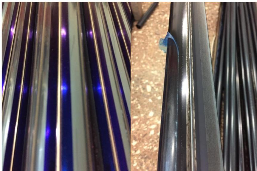
*Abbildung 46: Links Aluminium IR – Reflektorschicht, rechts ZrOx Antireflexschicht*
