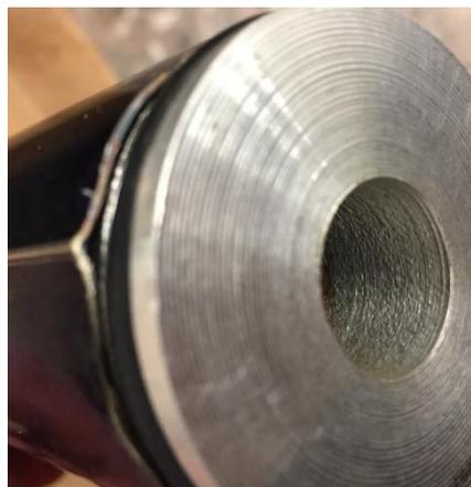
*Abbildung 68: Nahtüberhöhung trotz Richtrollen*
