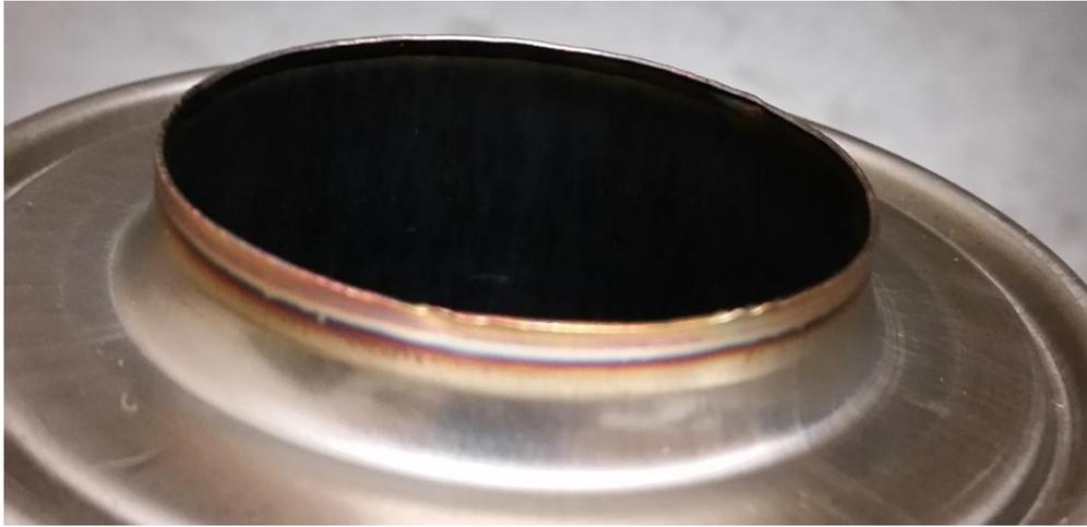
*Abbildung 83: WIG-Schweißung - Stoßnaht*
