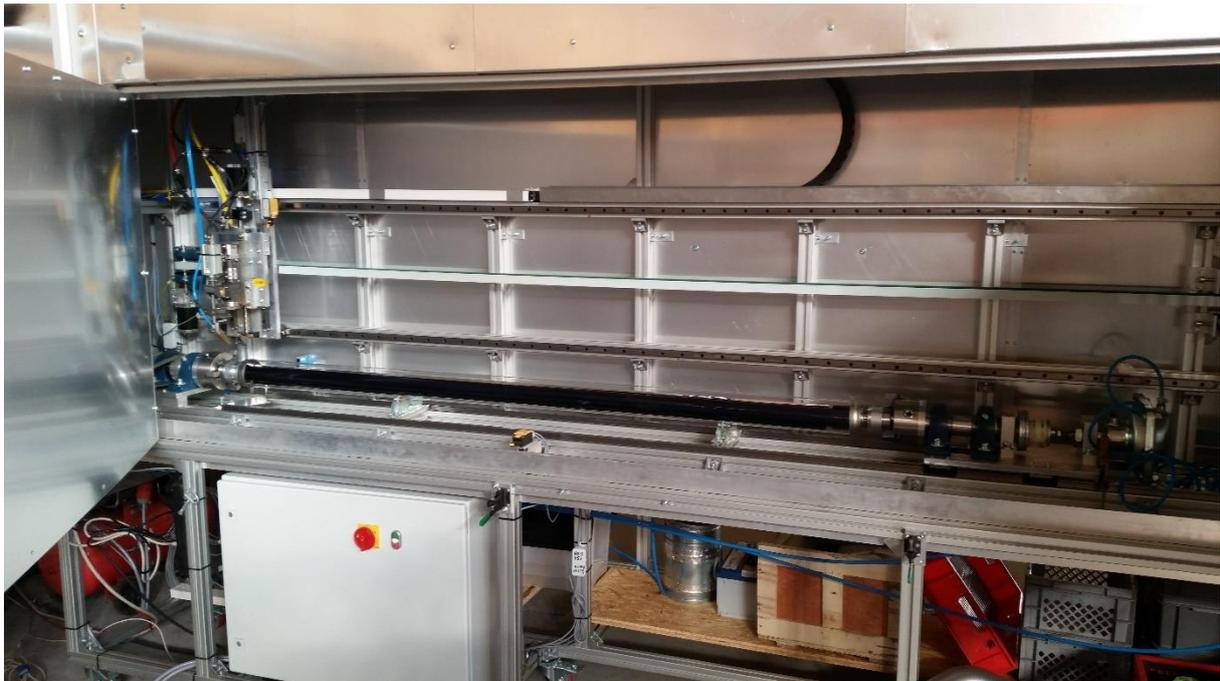
*Abbildung 84: Absorber-Laser-Schweißanlage (ALSA)*
