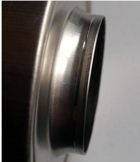
*Abbildung 85: Laser-Überlappnaht*
