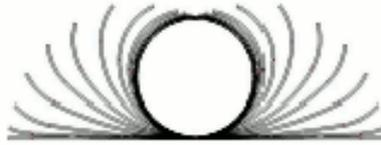
*Abbildung 51: Verschiedene Schablonenstufen zum Rohrformen - Rohrblume*
