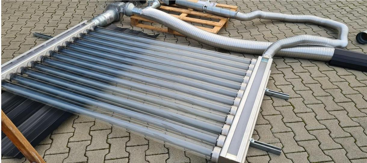
*Abbildung 118: Transparenter TSTair-S am Nebelteststand*
