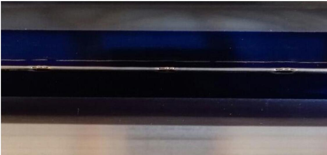
*Abbildung 47: Schweißfehlerreihe - Längsnaht*
