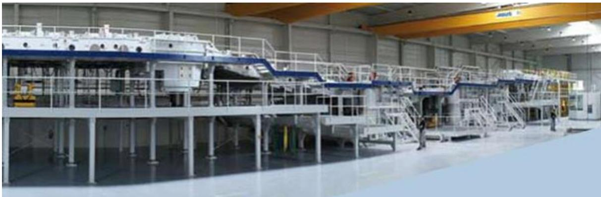
*Abbildung 8: Industrielle air to air PVD Bandbeschichtungsanlage der Almeco GmbH in Bernburg*
