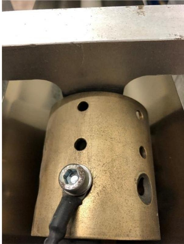
*Abbildung 55: Massenbindung über Schleifbuchse*
