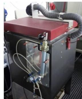
*Abbildung 102: Snijstaal P2000 Ofen für Temperaturstabilitätstest an Luft.*
