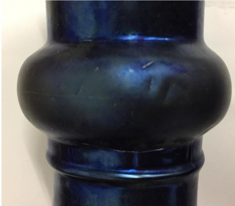
*Abbildung 69: Vorgeformte Einzelwelle mit Hydroumformung*
