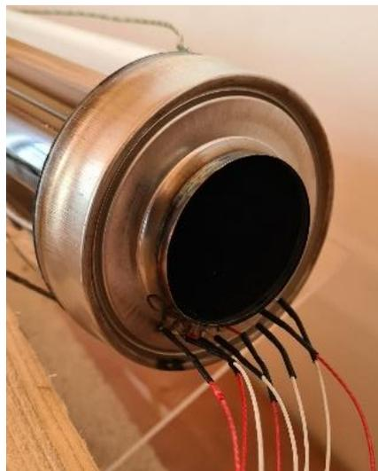
*Abbildung 91: Vakuumdurchführung von Temperatursensoren*
