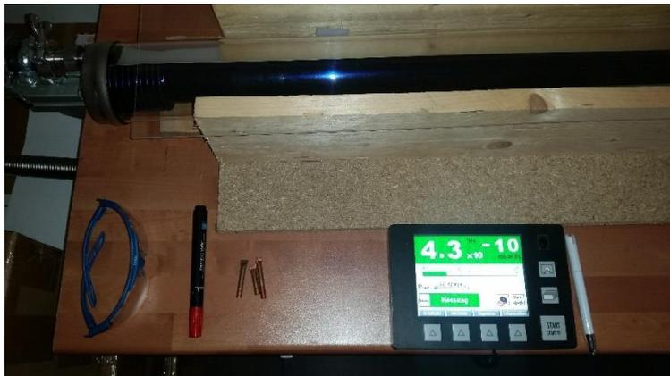
Abbildung 88: Heliumleckagetest an einer Absorberröhre
