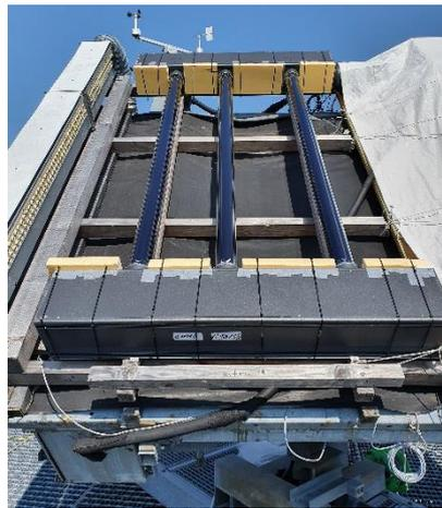
*Abbildung 120: Messung mit 3 Absorberröhren und hohen spezifischen Volumenströmen*
