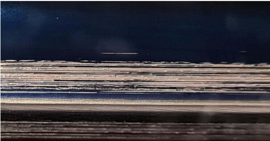
*Abbildung 44: Längskratzer auf Absorberrohr nach Umformung*
