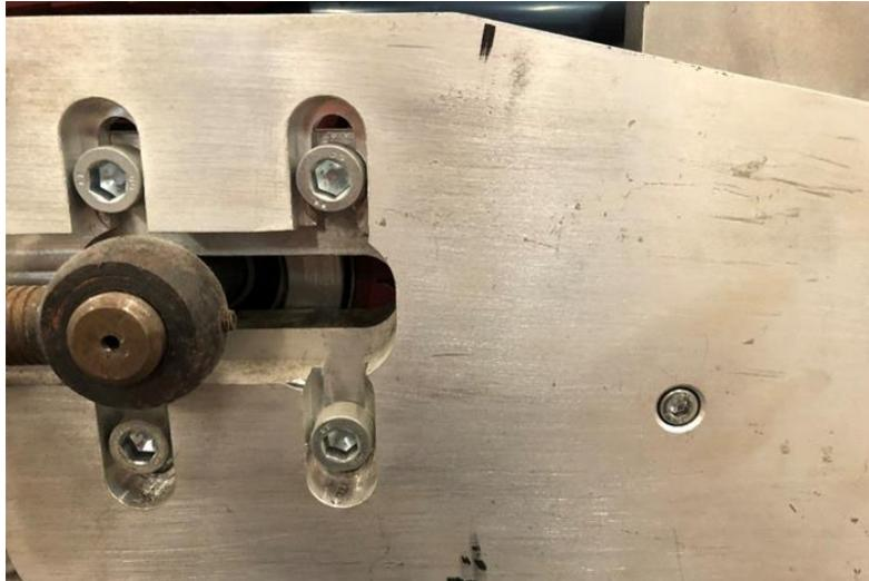
*Abbildung 59: Verstellmöglichkeit der Abzugsvorrichtung*
