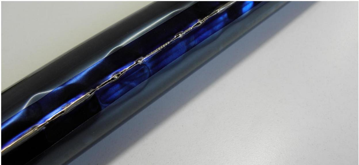
*Abbildung 49: Schweißfehler mit WIG an der Längsnaht*
