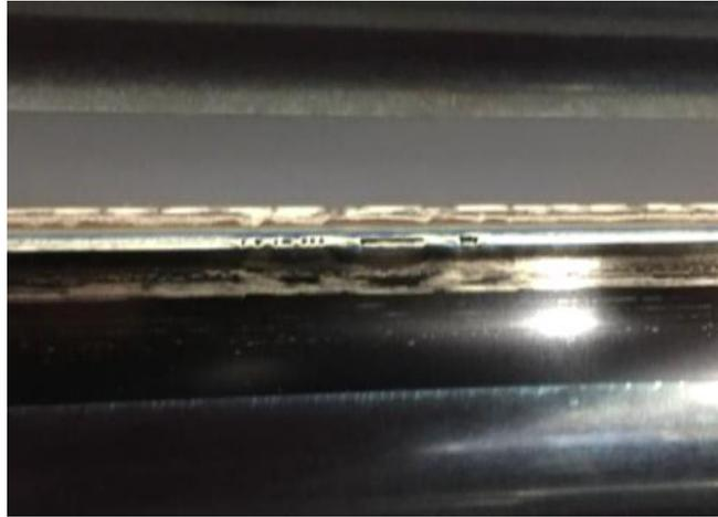
*Abbildung 38: Schweißnaht des Absorbermaterials mit ZrOx Antireflexschicht.*
