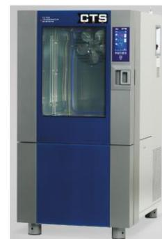
*Abbildung 104: CTS-Klimakammer für die Korrosionstests.*
