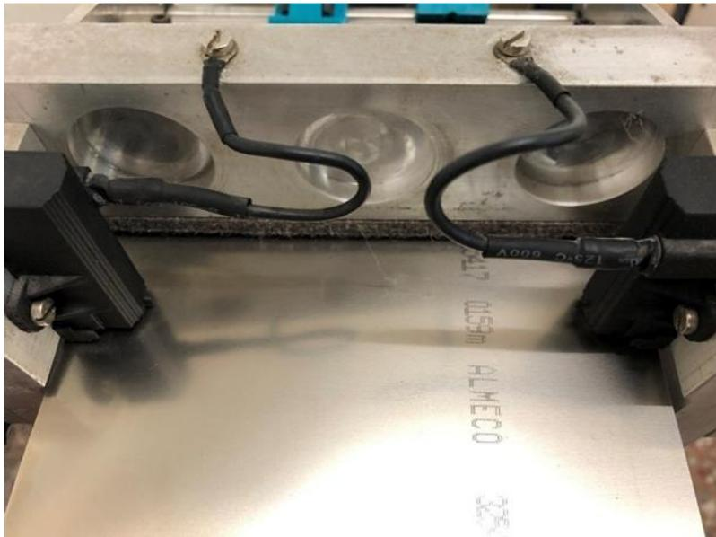
*Abbildung 54: Masseanbindung über gefederte Kohlen*
