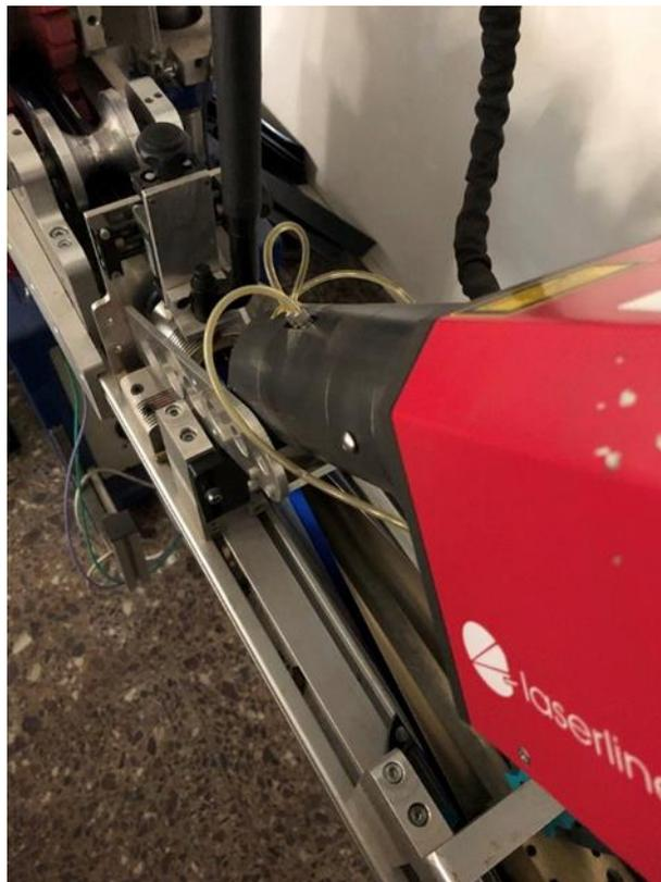
*Abbildung 58: Montageposition Laser in Rohrschweißanlage*
