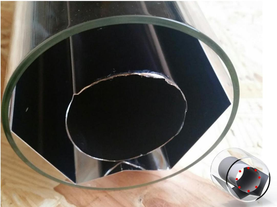
*Abbildung 78: Glasröhre mit W-Spiegel und Absorberrohr*
