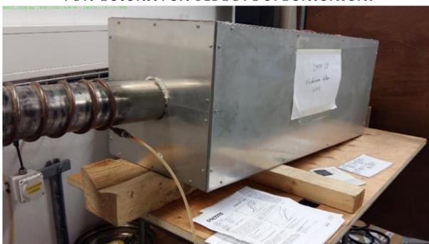
*Abbildung 103: SPF-Ofen für Temperaturstabilitätstests im Vakuum.*
