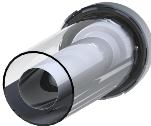
**Abbildung 9: Halbspiegel aufgedampft auf Glasinnenrohrseite**
