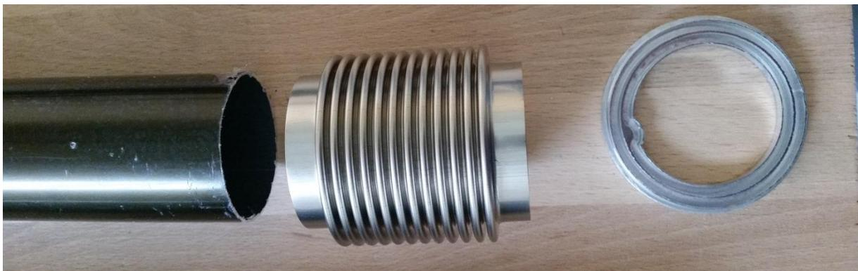
Abbildung 1: Materialmix - Absorberkomponenten
