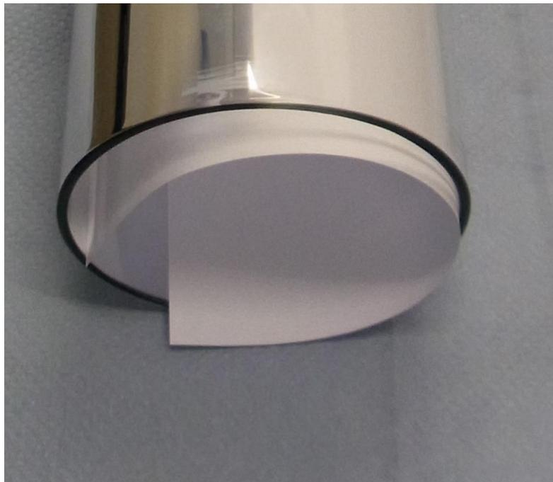
Abbildung 10: PVD-Beschichtungstest an einem kurzen Glasrohr 300 mm
