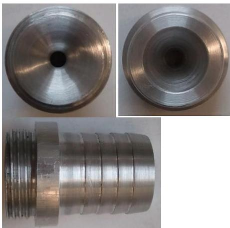
Abb. 29: alternativer Lavaldüsenaufsatz zum Anschrauben an die Ionendüse
