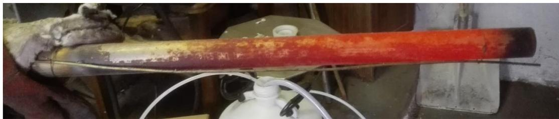
Abb. 65: lange Zweistoffdüse mit Thermoelement nach Betrieb in Brennkammer, Nachbrennkammer
