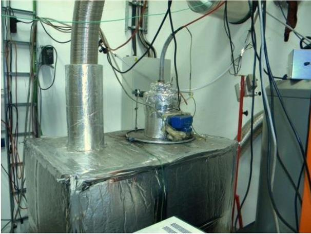
Abb. 46: Lüftungskanalsegment mit Aufladermodul (mittig)
