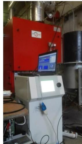
Abb. 41 Messung der Partikelgrößenverteilungen mit FMPS und Verdünnung
