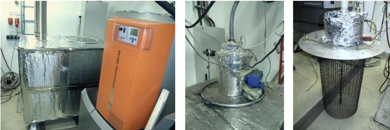
Abb. 78: Abscheidebehälter mit Aufnahmeflansch für das Aufladermodul und Pelletkessel (li.), Aufladermodul eingebaut (mi.), Aufladermodul ausgebaut (re.)
