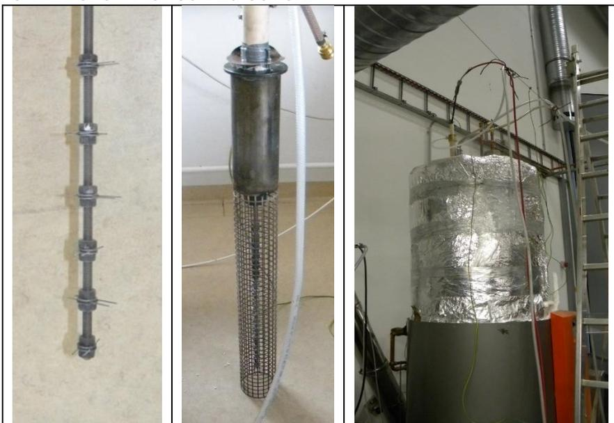
**Abb. 60:** Elektrode (li.); Multicharger (mi.); Brennkammeraufsatz (re.)
