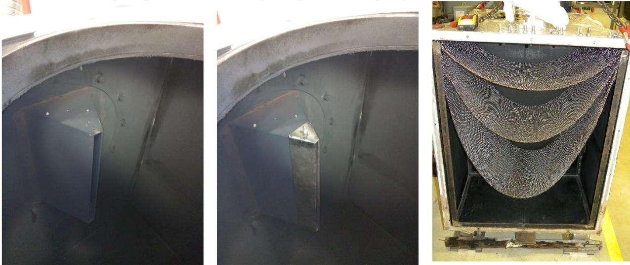
**Abb. 81:** Variation der Einströmgeschwindigkeit mit erweiterbarer Einströmdüse auf der Aufladerseite (li. und mi.), optionales Netz zur Strömungsvergleichmäßigung auf der Abscheiderseite (re.)
