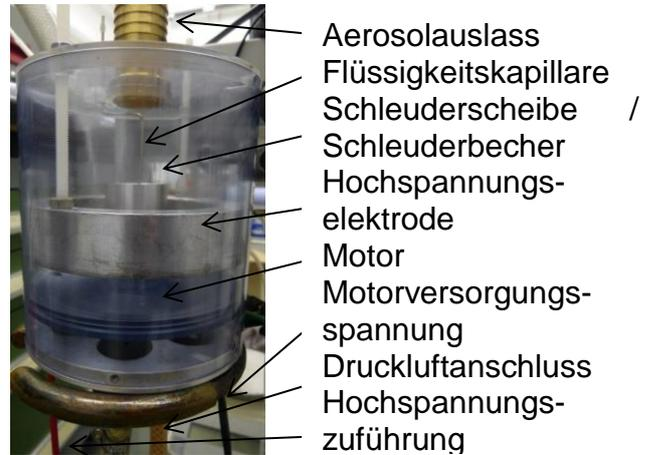
Abb. 2 schematischer Aufbau des elektrostatischen Rotationszerstäubers
