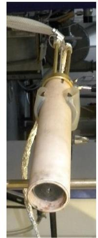
**Abb. 58:** Zeichnung der elektrostatischen Zweistoffdüse für hohe Temperaturen; **Abb. 59:** Düse vor dem Einsatz
