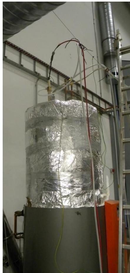
**Abb. 44:** geplanter Brennkammeraufsatz für Hochtemperaturversuche am Versuchspelletofen
