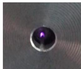
Abb. 19: Ionendüse im Betrieb (an der Sprühelektrode ist eine Koronaentladung am lila Glimmen erkennbar)
