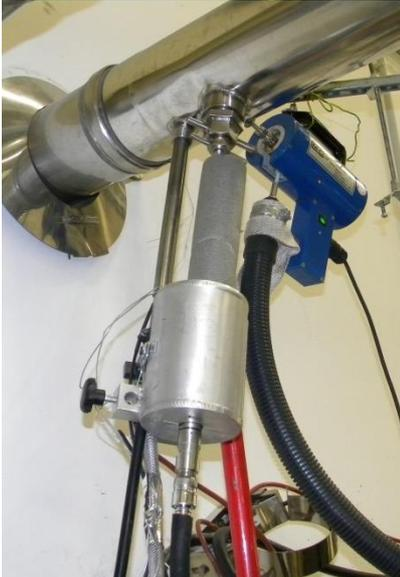
Abb. 48: Anschlüsse der beheizten Sonden; auf dem Bild Verdünnungssonde (li.), grav. Paul-Gothe (mi.), Gasanalyse (re.)
