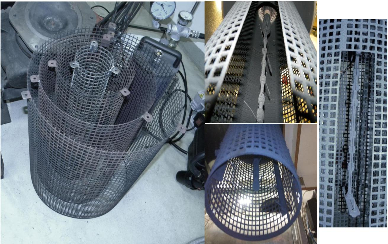
Abb. 80: Variation der Gegenelektrode; Gitterdurchmesser (li.), Prallblech zur Strömungsführung (li., o.), mit Gegenkoronalektroden (li., u.), an der Einströmseite geöffnet (re.)
