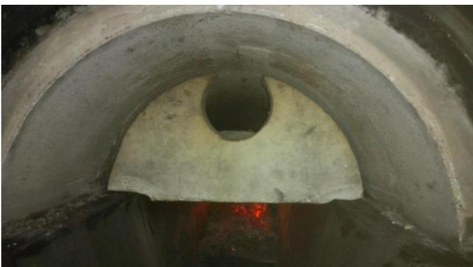
Abb. 43: Optionaler Brennkammereinbau zur Anpassung der Strömungsführung
