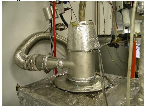
**Abb. 82:** schematischer Aufbau des optimierten Aufladermoduls mit tangentialem Eingang und durchgängiger Rohr-Gegenelektrode im Abscheidebehälter (li.); tangentialer Einlauf und Hochspannungsversorgung des Moduls (re.)
