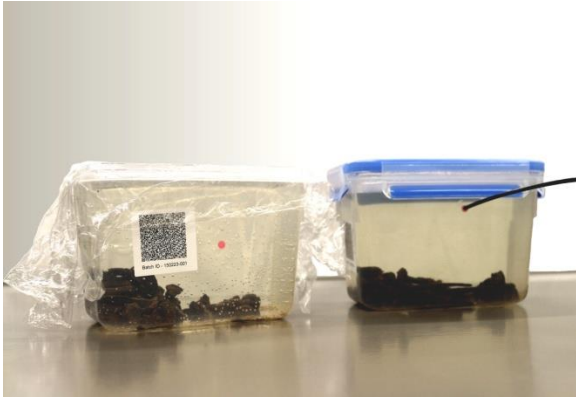
Abb. 6 Plastikbox, abgedeckt mit PE-Folie (nicht luftdicht) und mit mit Silikondichtung (luftdicht)
