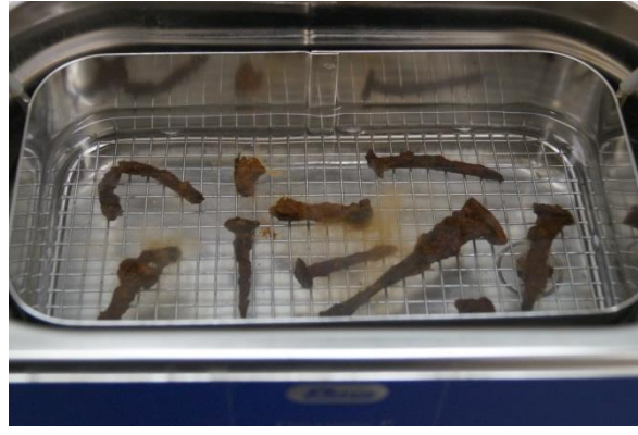
Abb. 7 Ultraschallanregung im Edelstahlbehälter (nicht luftdicht), Korrosionsprodukte werden aufgeschwemmt
