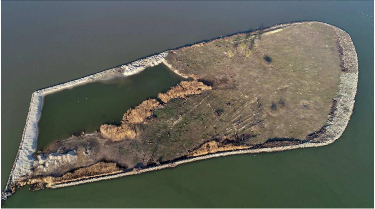
*Bild 10: Luftbild der Vogelinsel nach Abschluss aller Arbeiten im Februar 2019. Alle Ufer der Lagune sind nun mit Sand und Schotter bedeckt.*
