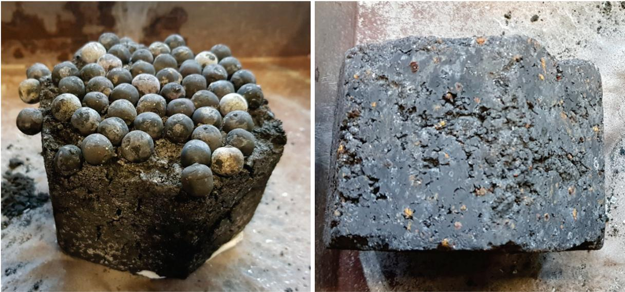
Bild 9: Probekörper mit und ohne Keramikugeln (nach RuL – Test)
