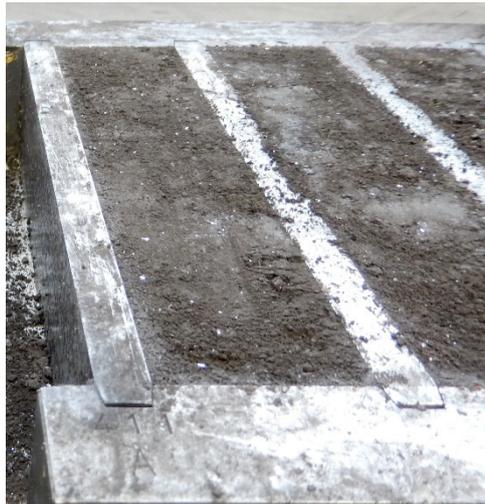
Bild 3: Probekörper in Langform nach dem Verpressen
