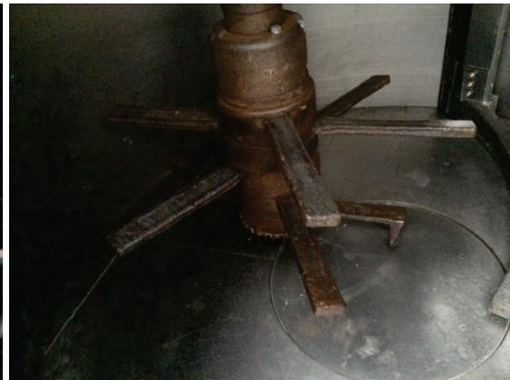
Bild 19: Mischwerkzeug des Eirich – Mixchers
