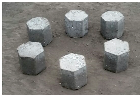
Bild 11: Agglomeratsteine hergestellt aus Konverterschlämme für das Stahlwerk B
