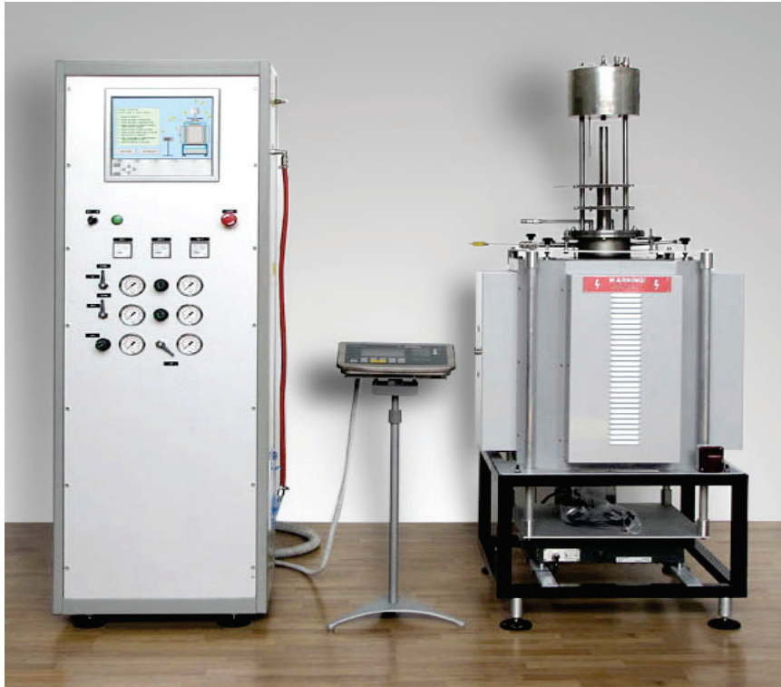
Bild 6: Messeinrichtung für den RUL-Test
