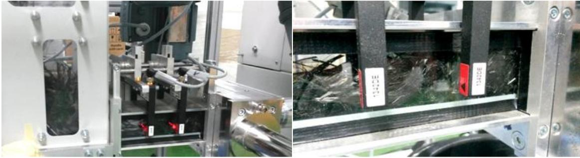
**Abbildung 6: Brückenbildung infolge zu hohen Materialdurchsatzes (l) Optische Füllstanderkennung (r)**
