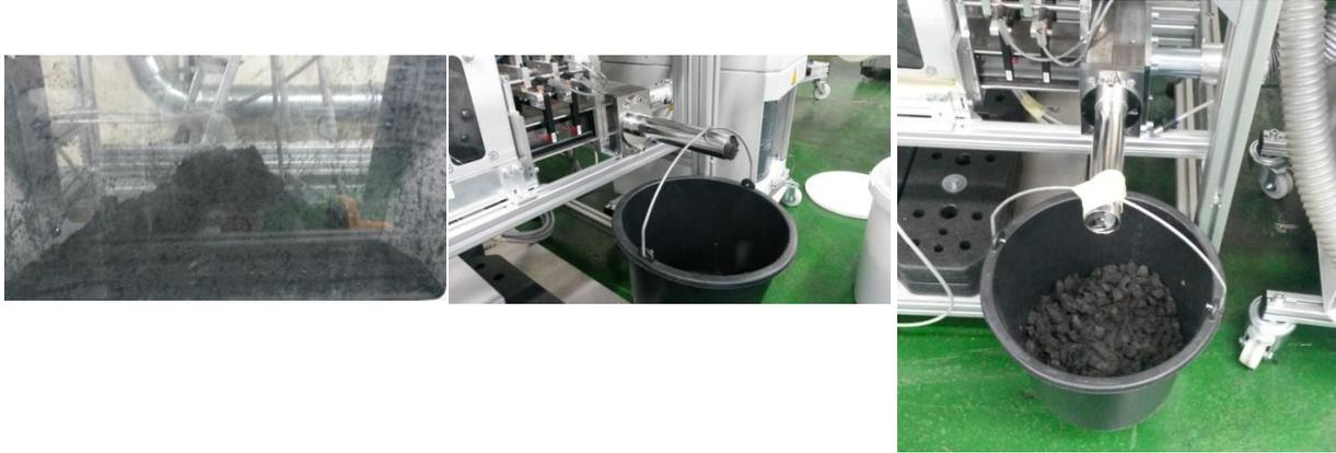
**Abbildung 15: Dosiervorgang von Kurzfasern von links nach rechts: Ausgangsmaterial, Dosiervorgang, Zustand am Ende des Prozesses**
