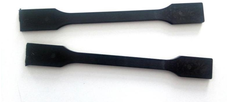
**Abbildung 16: Zugstäbe mit 30% Recyclingkohlefasern**
