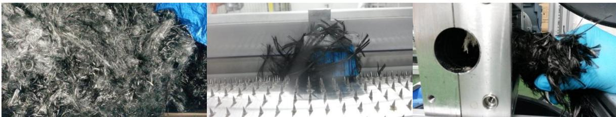
**Abbildung 14: Quasiendlofasern: Ausgangsmaterial (l), Knäuelbildung an der Nadelwalze (m), Blockieren der Förderschnecke (r)**
