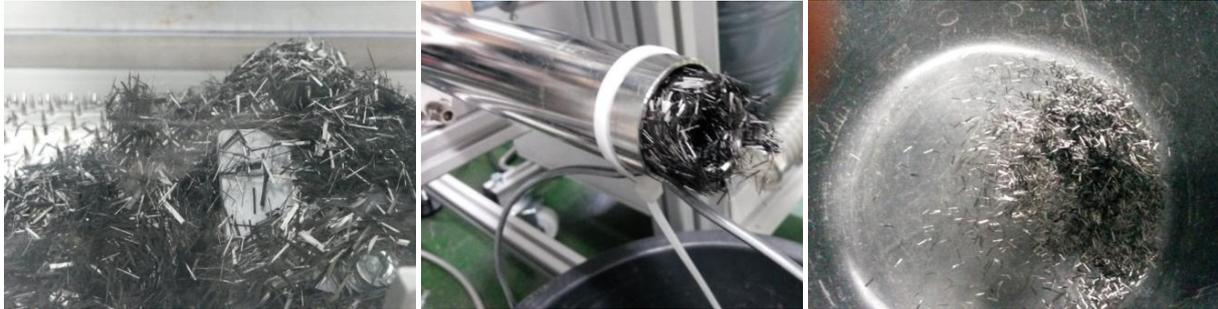
**Abbildung 13: Dosierung von Langfasern von links nach rechts: Ausgangsmaterial, Dosiervorgang, Zustand am Ende des Prozesses**
