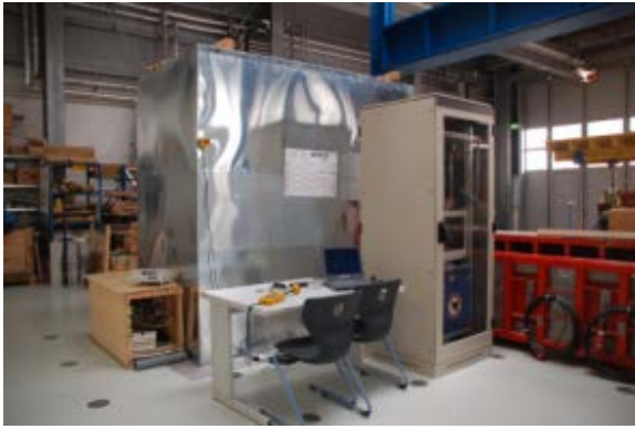
Abb. 4 Versuchsaufbau zur RW-Erwärmung von großvolumigen Probekörpern im Technikum der Fakultät Bauwesen der HTWK Leipzig (RF-3)
