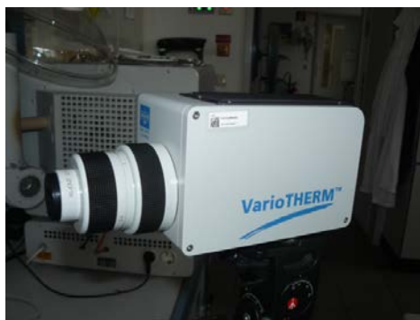
Abb. 7 Für die unterschiedlichen Erwärmungsversuche verwendete IR-Thermokameras: System VarioTherm ( links ) und System ImageIR 8300 ( rechts )
