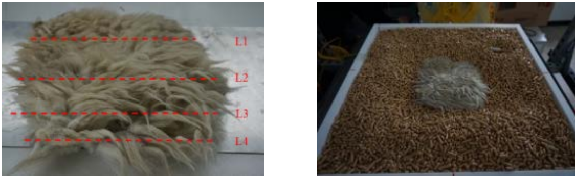
Abb. 76 Schafsfell mit der Anordnung der 1D-Temperaturmessfaser ( links ) sowie Platzierung des Probekörpers in der Mitte der Schüttbettmatrix ( rechts )
