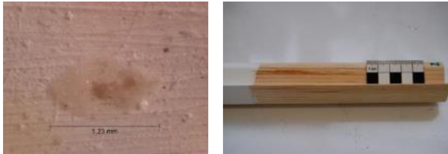
Abb. 41 Harzaustritte auf dem Kreidegrund ( links ) und Harzaustritte auf der leimbehandelten Holzoberfläche ( rechts ) nach einer thermischen Behandlung bei T = 80^{\circ}\text{C} (im vorliegenden Fall mittels RW)
