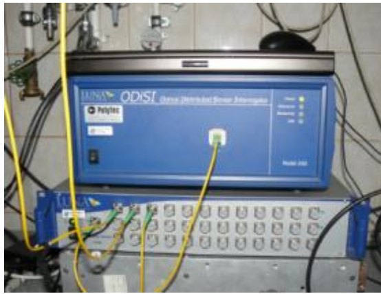
Abb. 6 Optisches Temperaturmessgerät ODiSi der Fa. Luna Technologies für eine auf der Rayleigh-Streuung basierenden Temperaturmessung entlang einer optischen Faser
