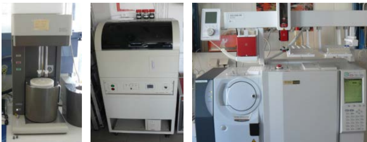
Abb. 19 BELsorp Mini II zur Bestimmung der spezifischen Oberfläche poröser Materialien ( links ), Chemisorptionsmessgerät BELCAT-B zur Durchführung von temperaturprogrammierten Messungen und zur Dispersitätsbestimmung ( Mitte ) und Gaschromatographie-Massenspektrometrie-System GC-MS-System QP 2010 zur stofflichen Analytik ( rechts )
