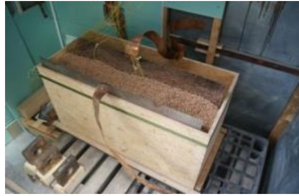
Abb. 4 Versuchsaufbau zur RW-Erwärmung von großvolumigen Probekörpern im Technikum der Fakultät Bauwesen der HTWK Leipzig (RF-3)
