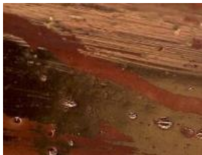
Abb. 42 Beschädigte Goldauflage nach einer thermischen Behandlung bei einer Temperatur von ca. 81^{\circ}\text{C} und nach erfolgtem Abriebtest
