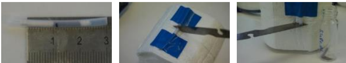
Abb. 152 Bilder zur Versuchsdurchführung von Experimenten zur Bestimmung des effektiven Diffusionskoeffizienten in porösen Schüttbetten: PTFE-Schlauchabschnitte gefüllt mit Pd/ \gamma -Al 2 O 3 (grau) bzw. \gamma -Al 2 O 3 (weiß), beidseitig verschlossen mit Wasser und Teilung des Schlauchs mittels Skalpell 1 mm von der Grenze beider Komponenten versetzt
