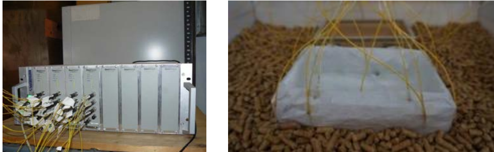
Abb. 5 Verwendetes faseroptisches Temperaturmesssystem ( links ) und Detaildarstellung mit an einem Untersuchungsobjekt angebrachten Einpunkttemperatursensoren ( rechts )
