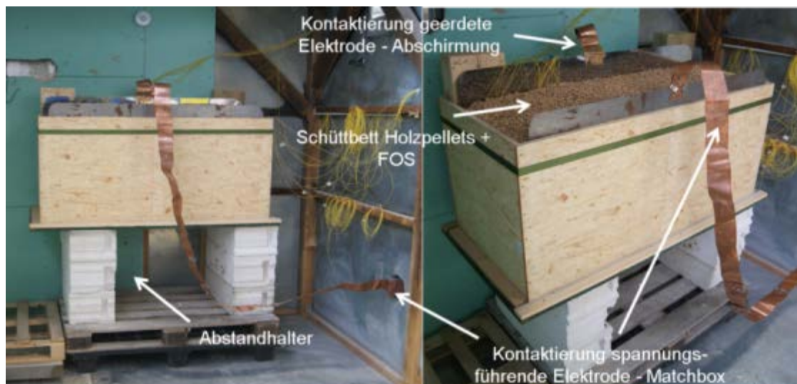
Abb. 84 Anordnung zur RW-Erwärmung der Tierpräparate in einer Schüttbettmatrix der Anlage RF-3 mit Schüttbettreaktor, Zuleitungen zur Kontaktierung der Elektroden, Abschirmgehäuse und faseroptischen Temperatursensoren
