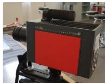
Abb. 7 Für die unterschiedlichen Erwärmungsversuche verwendete IR-Thermokameras: System VarioTherm ( links ) und System ImageIR 8300 ( rechts )
