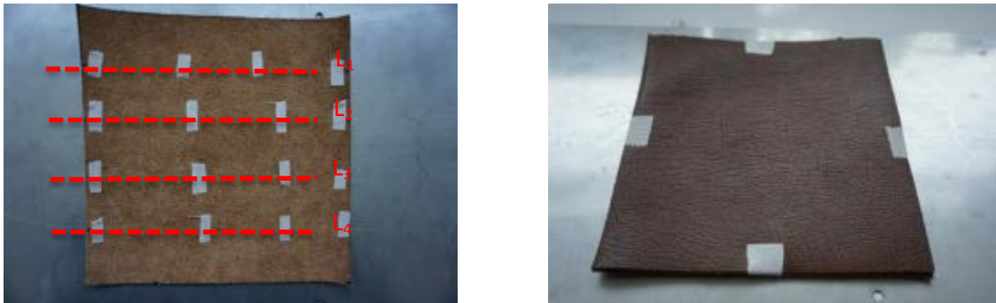
Abb. 73 Positionierung der vier Messabschnitte der Messfaser für die 1D-Temperaturmessungen zwischen zwei übereinander liegenden Lederstücken
