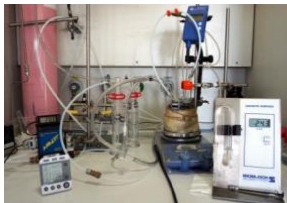
Abb. 18 Experimenteller Aufbau für die Dechlorierungsexperimente mit Realproben im Durchflussreaktor F3 mit Gaszuleitung, Gaswaschflaschen sowie temperierbarem Ölbad
