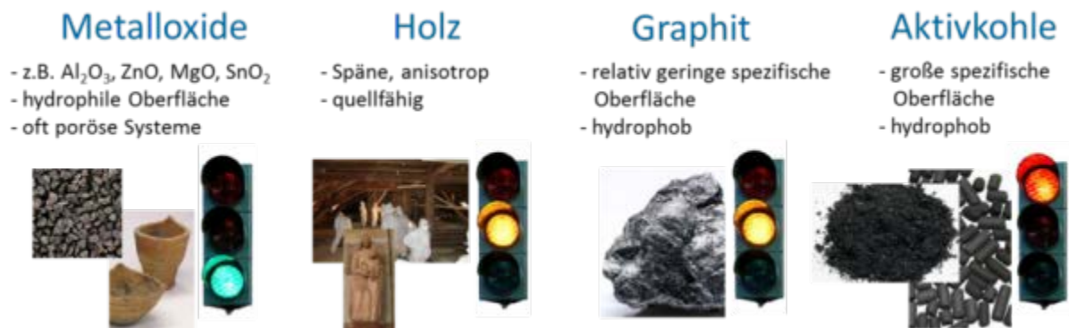
Abb. 160 Qualitative Übersicht über die HDC in mit DDT imprägnierten Mischsystemen, Wasserstoffbeladung bei Umgebungstemperatur (die Ampeln veranschaulichen die Qualität des Schadstoffabbaus)
