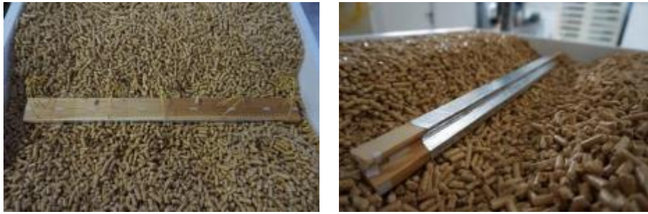
Abb. 33 Unterschiedliche Anordnungen von Probekörpern mit einer dünnen Metallschicht im Schüttbettreaktor für oben und unten platzierte Elektroden
