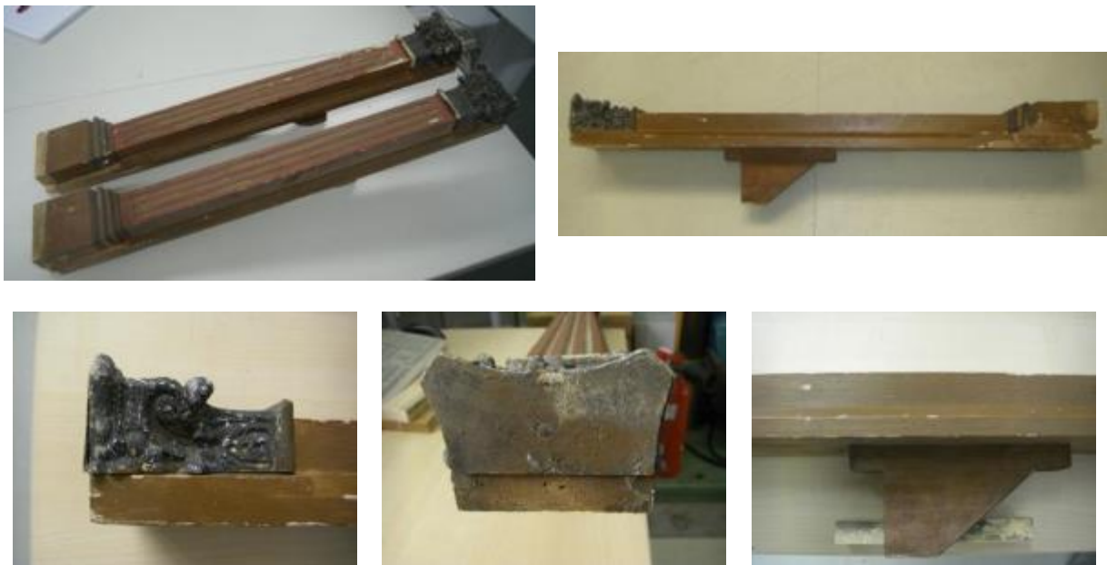
Abb. 44 Bei der RW-Erwärmung eingesetzte Orgelbauteile in der Gesamtansicht ( oben ) sowie Detaildarstellungen des verzierten Metallbeschlages und der angebrachten Holzbauteile ( unten )
