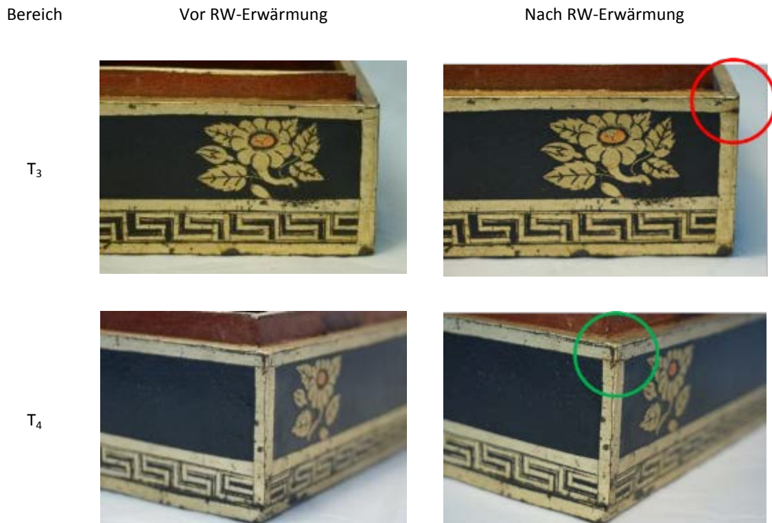
Abb. 64 Optische Gegenüberstellung von ausgewählten Eckbereichen um die Sensoren T_3 ( links und rechts oben ) und T_4 ( links und rechts unten ) vor und nach der RW-Erwärmung
