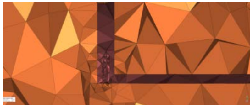
Abb. 12 Ausschnitt aus einem Modell, welches für eine FEM-Simulation unter Verwendung vieler, in ihrer Größe jeweils der lokalen Komplexität angepasster Tetraeder erstellt wurde
