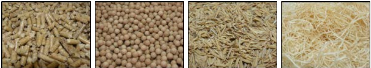
Abb. 28 Als Matrix für die Umhüllung der Kunstobjekte im Reaktor verwendete Materialien: Holzpellets, Buchenholzkugeln, Reisspelzen und Holzwohle (von links nach rechts)
