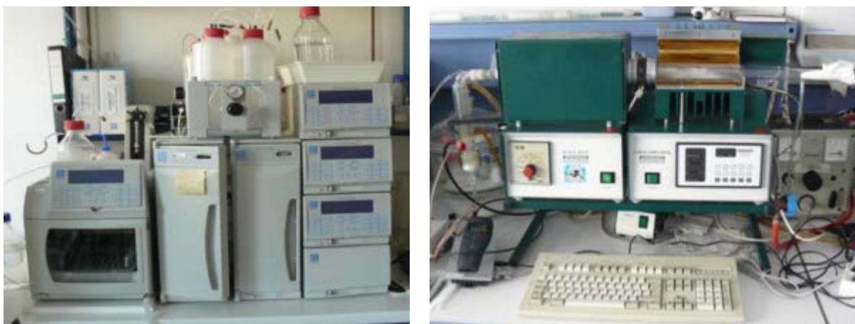
Abb. 20 Ionenchromatographiesystem DX 500 mit Anionenaustauschsäule AS11-HC, 4 mm-Suppressor ASRS 300 und Leitfähigkeitsdetektor IC-25 ( links ) und C-MAT-Kohlenstoffanalysator ( rechts )
