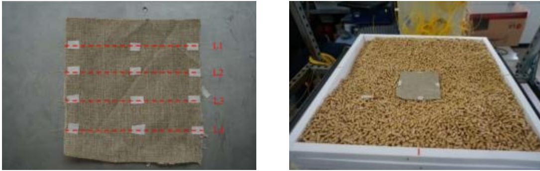
Abb. 79 Thermisch behandelter Leinenstoff mit der Positionierung der 1D-Temperaturmessfaser in vier Faserabschnitten ( links ) sowie Platzierung des Probekörpers in der Mitte der Schüttbettmatrix ( rechts )
