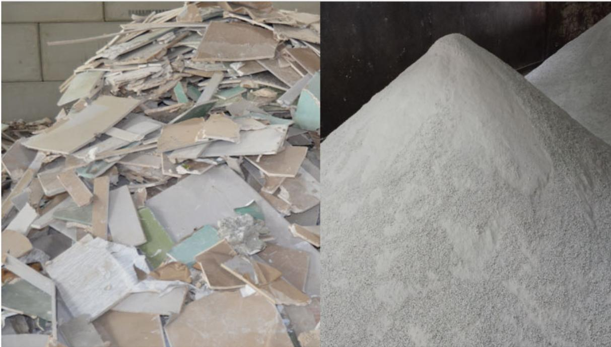
Abb. 4: Gipsabfälle und RC-Gips (Fotos:MUEG)
