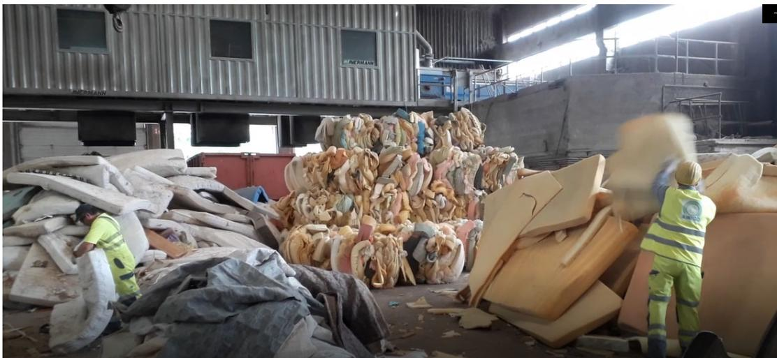
Abb. 6: Aussortieren von Matratzen für die Verwertung von Polyurethan-Schaumstoff (PUR) bei einem Tochterunternehmen von August Meyer Recycling in Osnabrück
