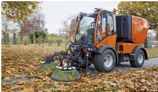
Abbildung 1: Holder Systemfahrzeug mit Knicklenkung
