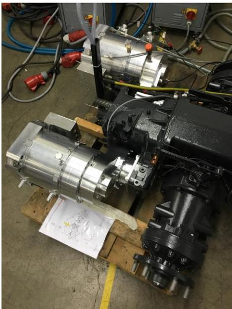
Abbildung 16: Holder Verteilergetriebe
