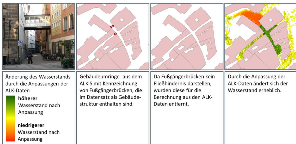
Abbildung 3: Wasserstands-Differenz-Karten, Beispiel: Auswirkungen auf den Wasserstand durch Berücksichtigung von Durchfahrten in Gebäuden.
