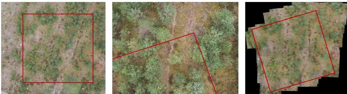
**Abbildung 25.** Möglichkeiten der Bildanalyse am Beispiel der Fläche BRE\_2: (links) Einzelaufnahme der Gesamtfläche aus 25 m Höhe; (mittig) Einzelaufnahme einer Ecke der Fläche in ca. 5 m Höhe und (rechts) automatisch zusammengesetzte Fläche aus den Einzelaufnahmen mithilfe der Software 'AutoStitch'
