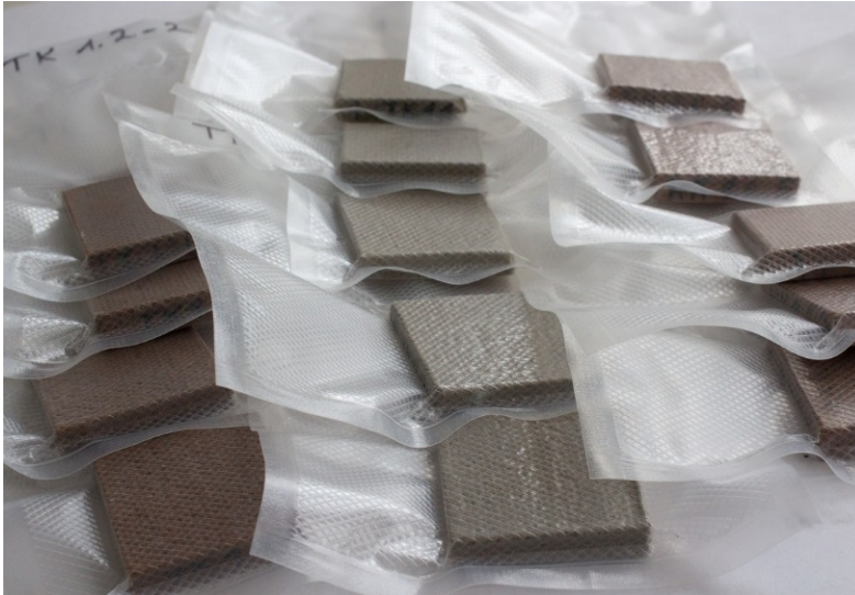
Abb. 7 Vakuumverpackte Prüfkörper der Prüfreihe FTW.
