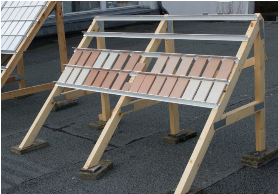
Abb. 8 Expositionsgestell mit Prüfkörpern; Ausrichtung Richtung Süden
