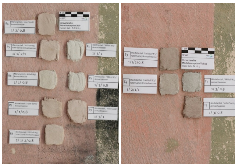
Abb. 2 (links) Versuchsreihe R1.-R8. Mörtelkonzeption mit Romazement Roman Kalk TL8 NHL5 (rechts) Versuchsreihe T1.-T4. Mörtelkonzeption mit Trass Kalk NHL5
