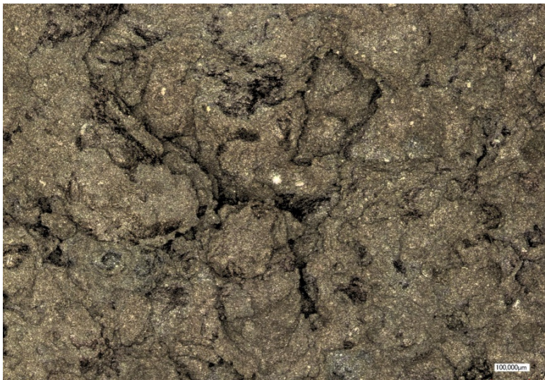
Abb. 9 Probenreihe FT RK1.2.1 in der Farblaseraufnahme, vor der Frost-Tau Wechsel Beprobung
