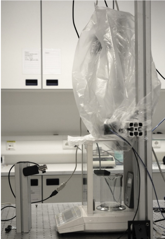
Abb. 38 Veränderter THz-Reflexionsmessaufbau mit Waage und Klimalogger
