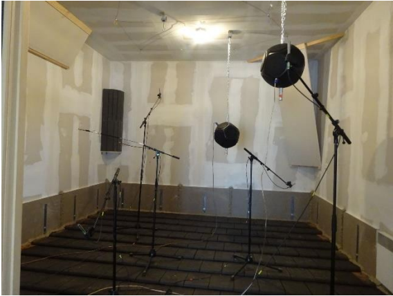
Abbildung 4-9: Schallmessung Dach – Senderaum (oben)
