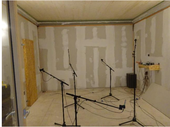
Abbildung 4-10: Schallmessungen Decke - Empfangsraum (unten)
