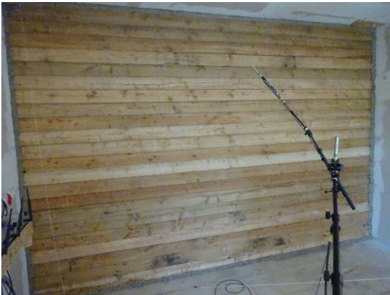
Abbildung 4-11: Schallmessungen Außenwand - Empfangsraum
