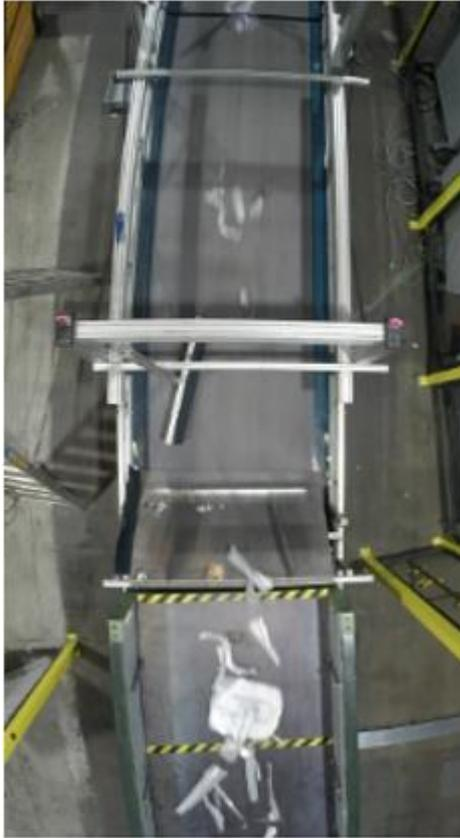
**Abbildung 35: Zuführrinne für Schrotte > 300 mm Kantenlänge**
