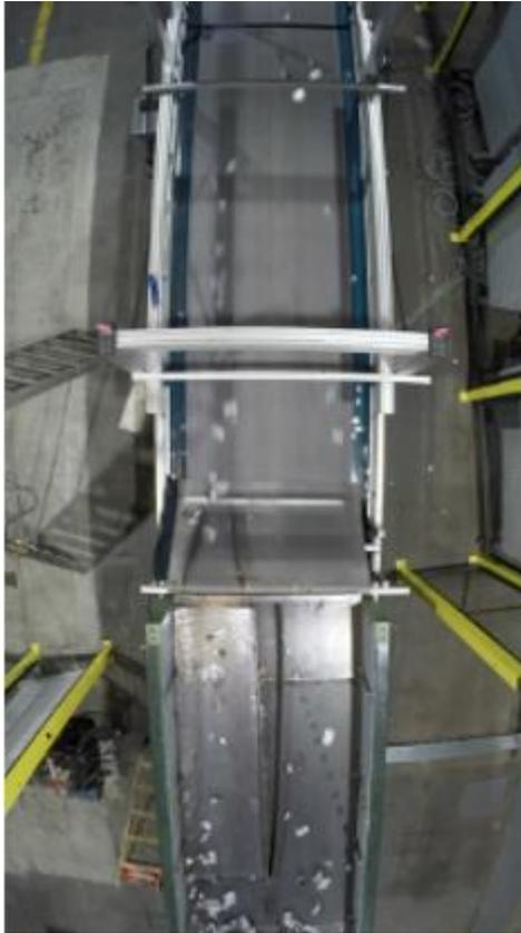
**Abbildung 34: Zuführrinne für Schrotte < 300 mm Kantenlänge**
