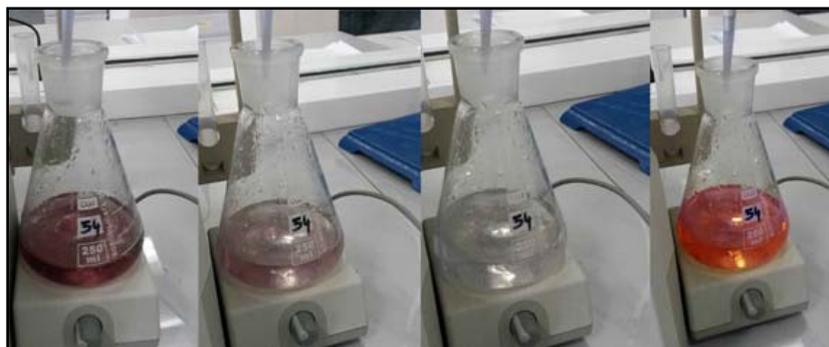
Abb. 6: Indikatorumschlag bei der Titration des nicht verbrauchten Mn(III)-Reagenzes
