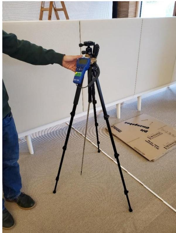
**Abbildung 97: Messaufbau für Luftgeschwindigkeitsmessung am Boden mit dem TSI**
