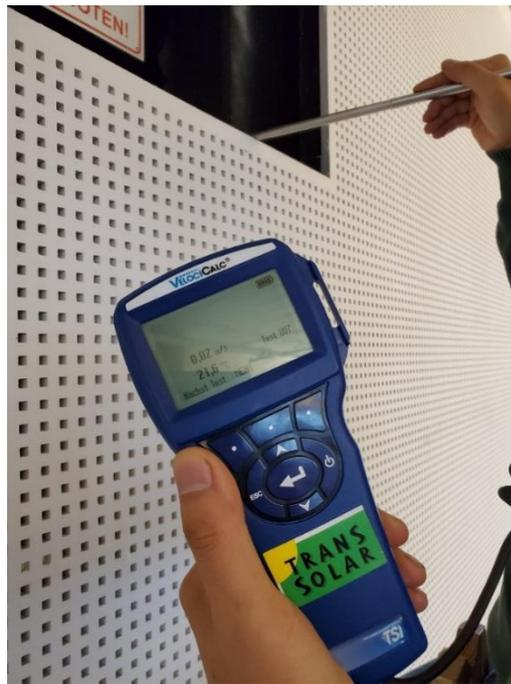
Abbildung 100: Messung der Luftgeschwindigkeit mit dem TSI im Schacht
