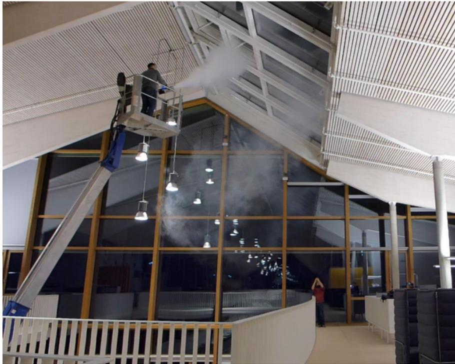
**Abbildung 117: Rauchversuch an den Oberlichtern ohne Blendschutz mit Konvektoren**
