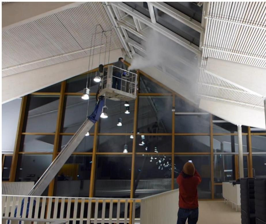
Abbildung 115: Rauchversuch an den Oberlichtern ohne Blendschutz und Konvektoren
