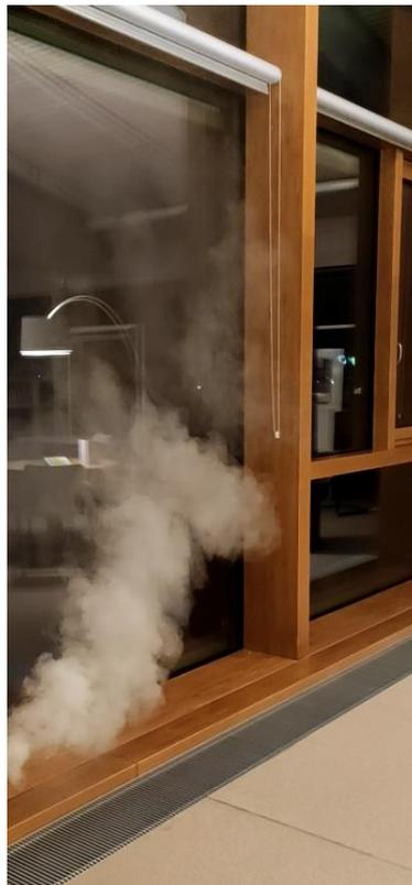
Abbildung 116: Rauchversuch an den Konvektoren
