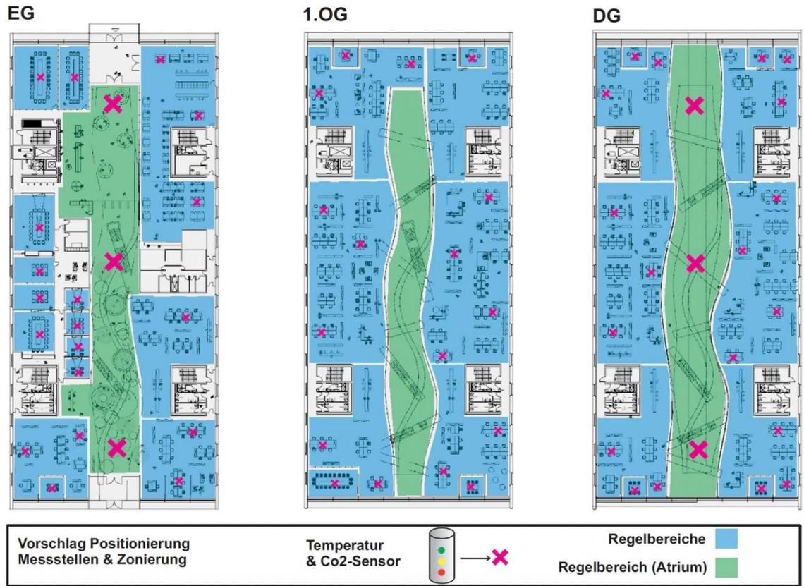
Abbildung 27: Regelbereiche und Sensor-Positionierung
