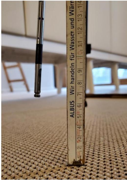
Abbildung 98: Messung Luftgeschwindigkeit am Boden in acht Zentimetern Höhe
