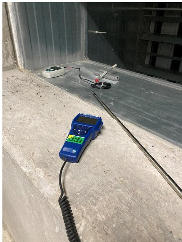
Abbildung 101: Messung der Luftgeschwindigkeit am Auslass RLT
