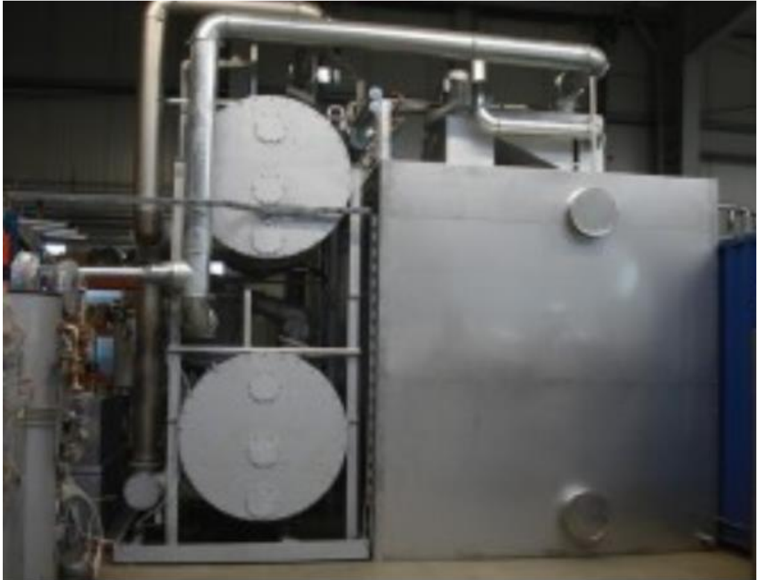
Abbildung 4. Rückansicht des Containers nach Abbildung 3 mit Aktivkohle-Filtern (vor Umstellung auf indirekte Adsorption)
