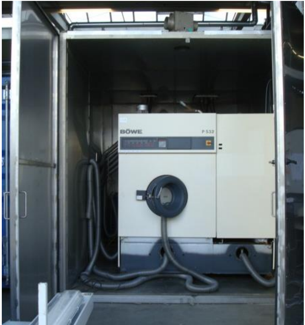
Abbildung 3: Edelstahlcontainer zur Rückgewinnung von Lösemitteln aus Altmaschinen
