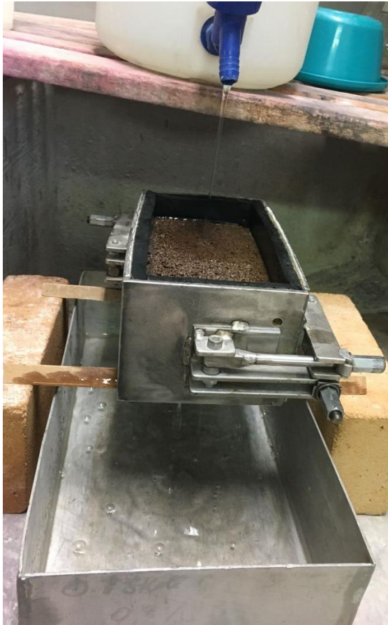
Bild 4: Einrichtung zur Bestimmung der Wasserdurchlässigkeit
