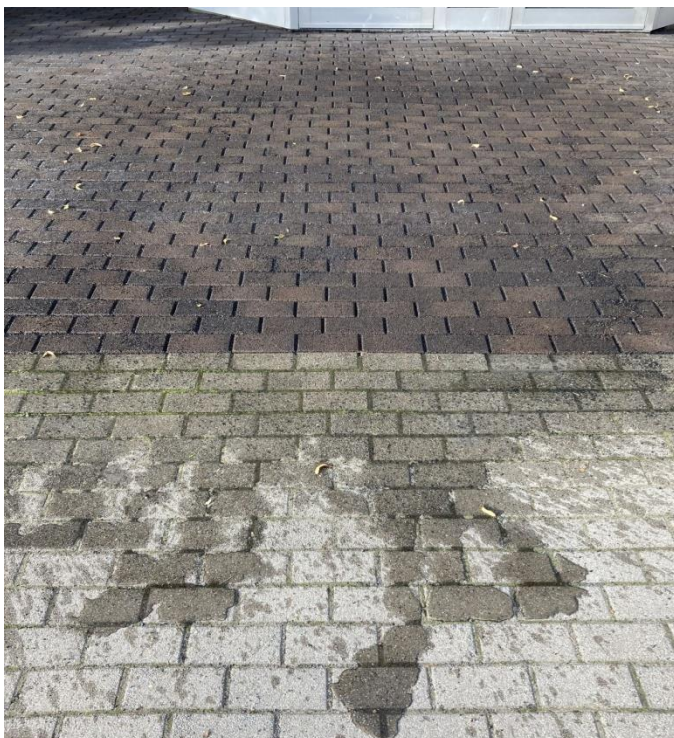
Bild 11: Grenze zwischen der Demonstrationsfläche mit wasserdurchlässigen Pflasterziegeln und dem Betonpflaster nach der Beaufschlagung mit Wasser.
