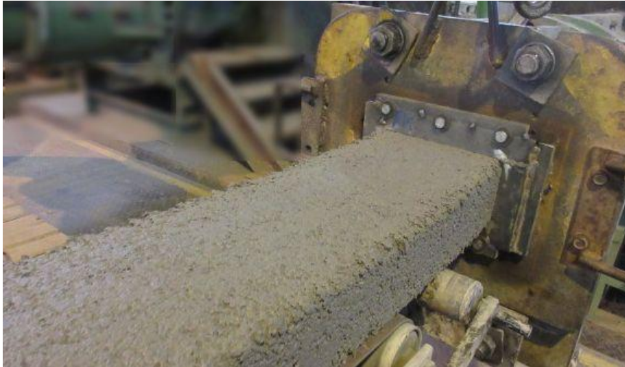
Bild 2: Strangpresse mit Versuchsmasse
