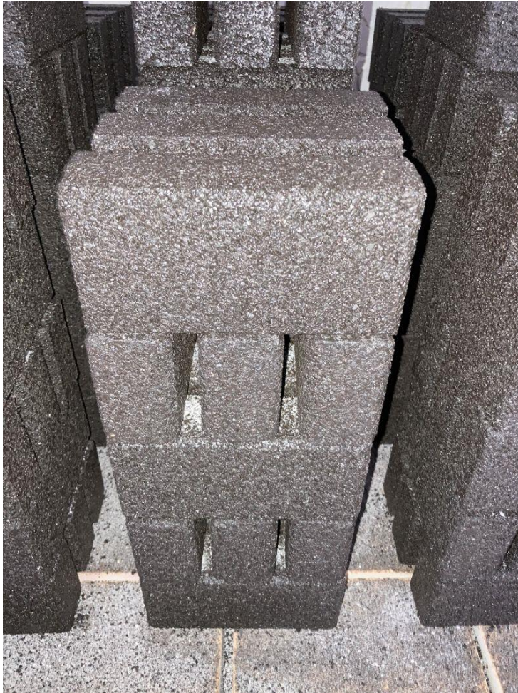
Bild 3: Stapelung der Ziegel im Ofen
