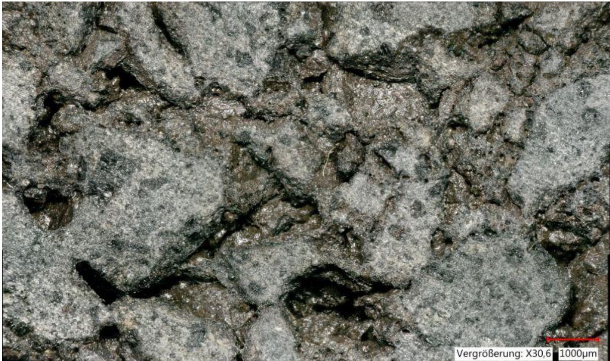
Bild 7: Sägefläche mit Poren im wasserdurchlässigen Pflasterziegel
