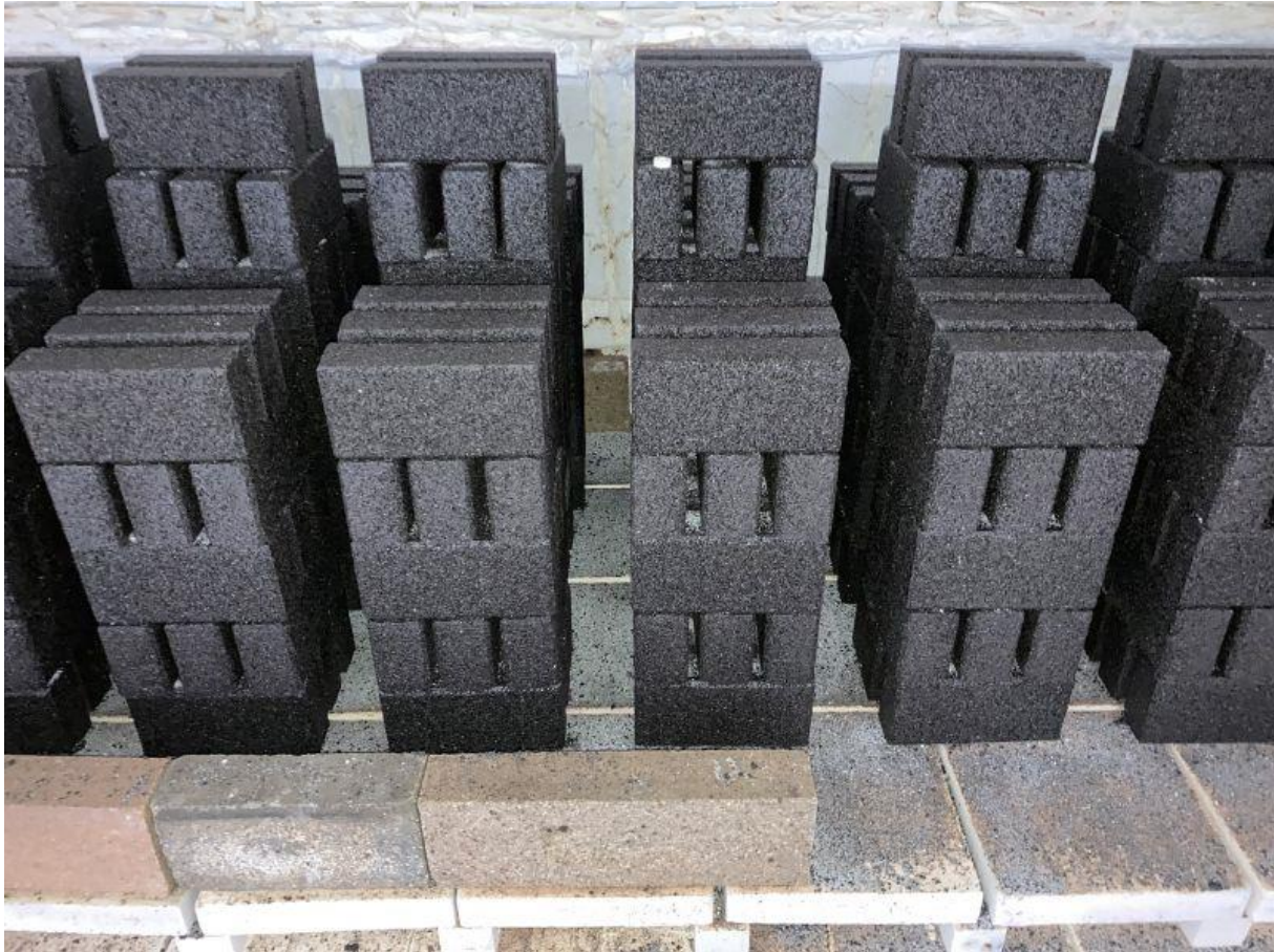
Bild 6: Wasserdurchlässige Pflasterziegel der Pilotproduktion nach dem Brand
