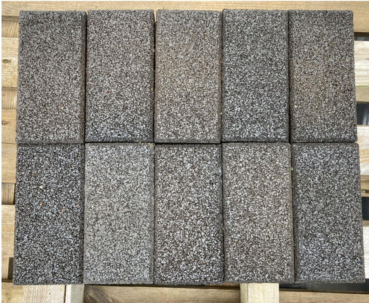
Bild 1: Keine Ausblühungen auf wasserdurchlässigen Pflasterziegeln aus der Pilotproduktion, nach 6 monatiger Lagerung im regenreichen Sommer/Herbst 2021
