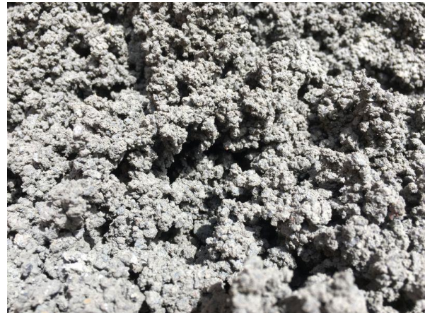
Bild 12: Masse G3; Nach dem Mauken, Detail
