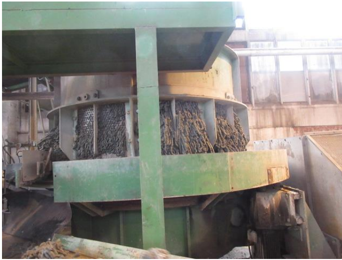
Bild 5: Siebrundbeschicker außen mit Lochscheibe und Transportband
