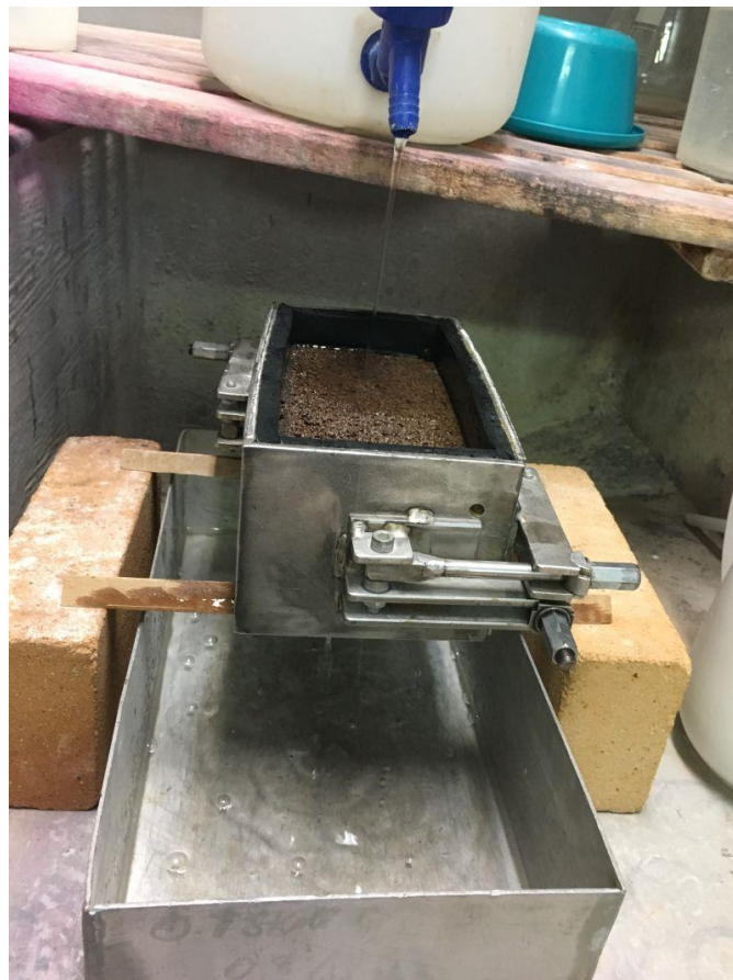
Bild 3: Einrichtung zur Bestimmung der Wasserdurchlässigkeit
