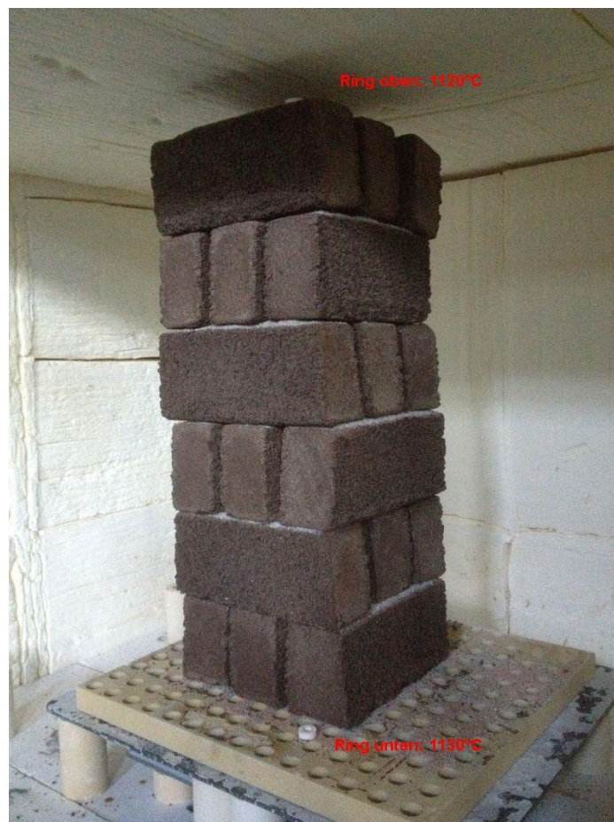
Bild 17: Stapelbrand Versatz G3, Ausbrandtemperatur 1130°C, mit am Brennring bestimmten Maximaltemperaturen
