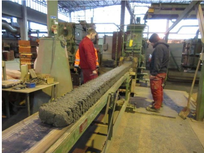
Bild 8: Extrusionsversuch der Masse V206 F4M-W5/Z4 mit ca. 21 Ma% Feuchte, Drachenzähne über den gesamten Strang
