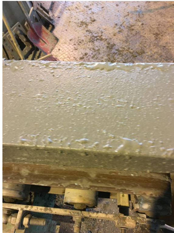
Bild 14: Strang aus der Masse G3 in einer Phase optimaler Feuchte (ca. 9%) mit eingeschalteter Bewässerung.
