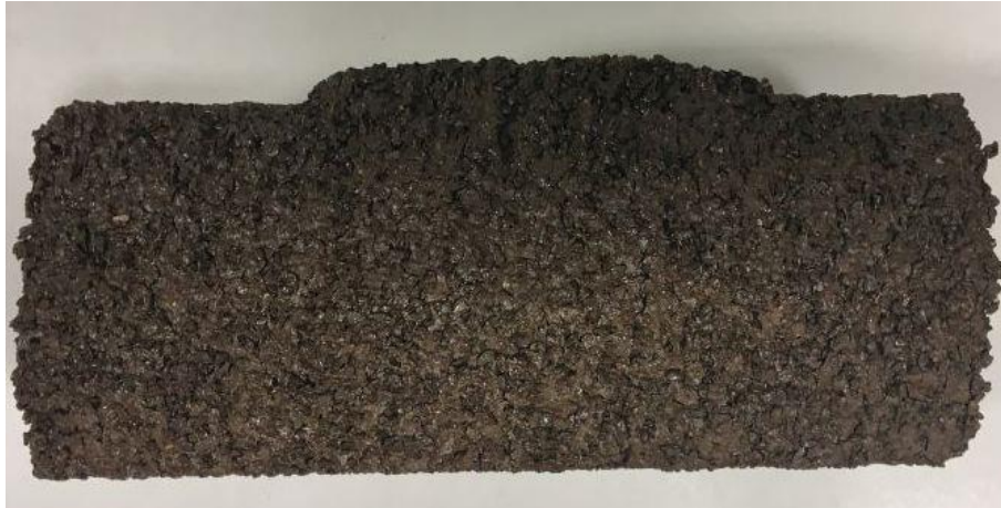
Bild 10: Extrudierte Masse nach Brand, Verformung durch Trocknung auf normaler Lattung
