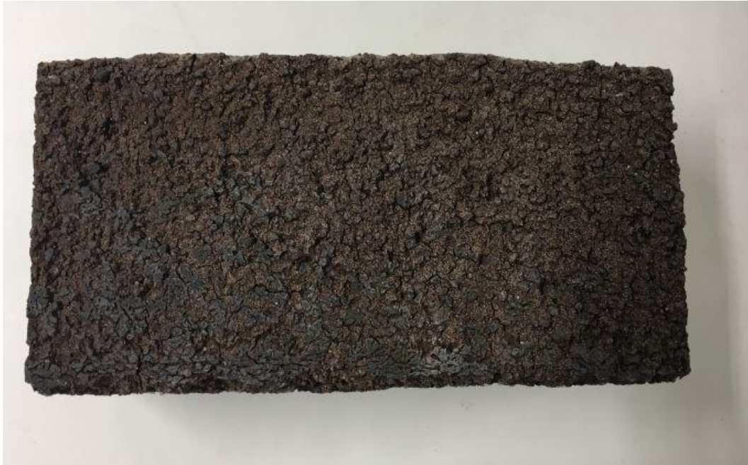
Bild 16: Pflasterziegel aus dem Versatz G3, stranggezogen und getrocknet bei Wienerberger, gebrannt im Keramik-Institut, 24h kalt zu kalt, Ausbrandtemperatur 1130°C
