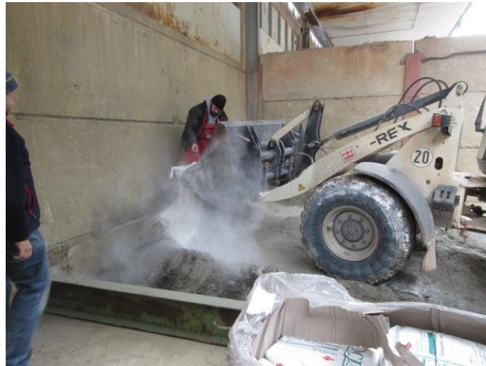
Bild 7: Staubentwicklung bei der Zugabe der Zellulose beim Vormischen in der Box
