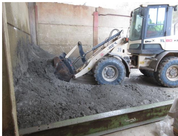
Bild 4: Manuelles Vormischen des Versatzes in einer Vorratsbox
