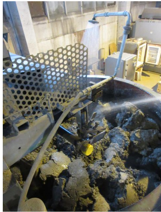
Bild 6: Siebrundbeschicker innen mit Brause zur Einstellung der Feuchte
