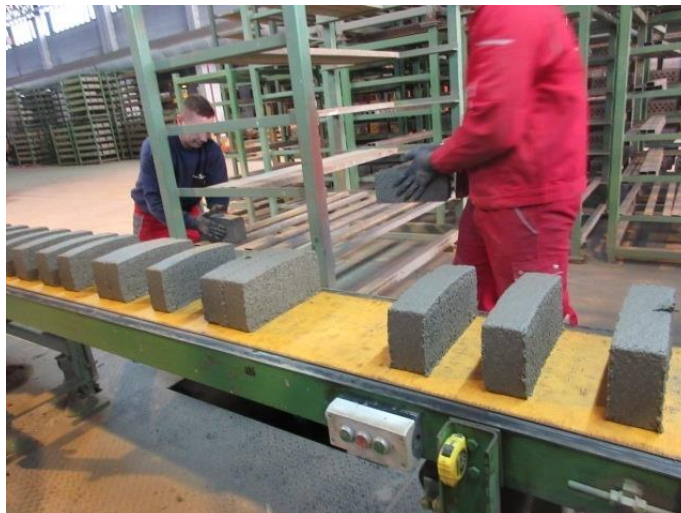
Bild 9: Extrusionsversuch der Masse V206 F4M-W5/Z4 mit ca. 22 Ma% Feuchte, Format 240x120, keine Drachenzähne aber Rückdehnungen nach dem Mundstück
