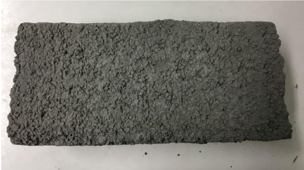
Bild 15: Pflasterziegel aus dem Versatz G3, stranggezogen und getrocknet bei Wienerberger
