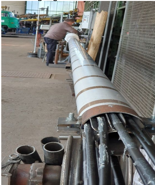
Abbildung 50: Koaxialrohr mit durchgeführten 16 mm PE-Rohren / auf das Außenrohr aufgefädelter PP-Schlauch
