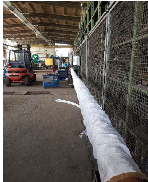
Abbildung 50: Koaxialrohr mit durchgeführten 16 mm PE-Rohren / auf das Außenrohr aufgefädelter PP-Schlauch
