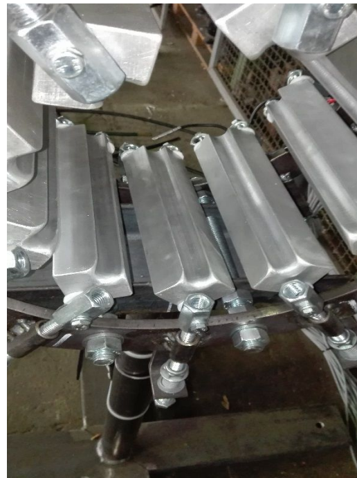
Abbildung 52: Aufheizvorrichtung (Detailaufnahme / Heizelemente mit Führungsnuten)
