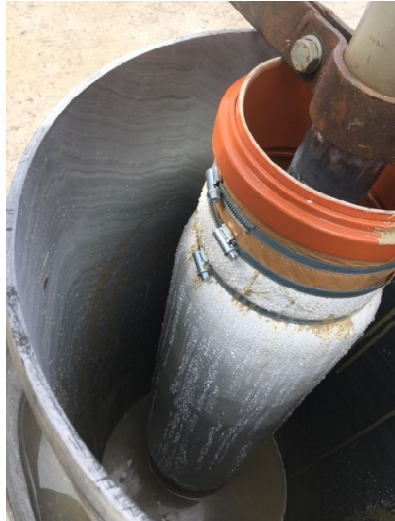
Abbildung 55: Versuchsanordnung für die Bruchlastbestimmung des Gewebeslauches gegen Innendruck
