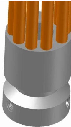
Abbildung 37: Sondenfuß mit 10 Außenrohren
