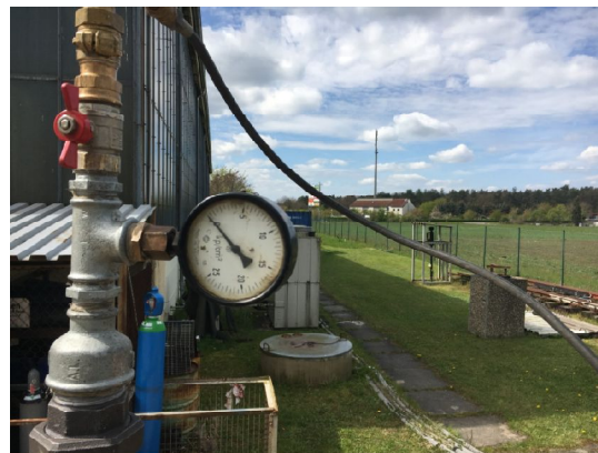
Abbildung 56: Überlagerungsdruckmessung für den Eignungstest des Gewebeslauches
