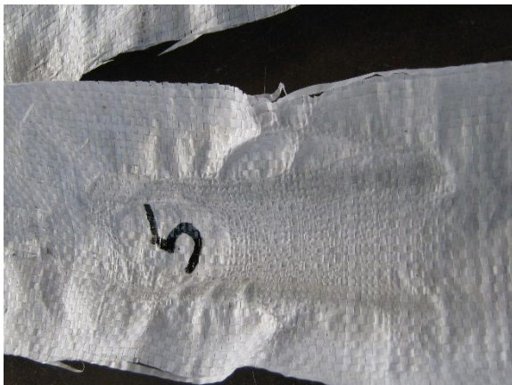
Abbildung 43: Begutachtung der Klebestelle / Versuch des Manuellen Lösens der Verklebung
