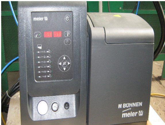
Abbildung 41: Klebstoffauftragseinheit / Manueller Auftragsversuch
