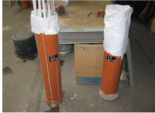
Abbildung 14: Einbau von PE-Vollstäben zur Simulation der Sondengeometrie / Probekörper vor Einbringen der Zementsuspension (rechter Kunststoffzylinder)
