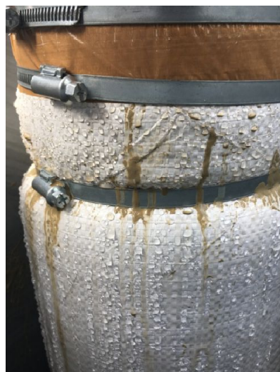
Abbildung 57: Maximale Innendruckbelastung während des Versuches auf den Gewebeslauches
