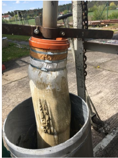
Abbildung 58: Ausbau des geborstenen Gewebeschauches nach dem Versuch
