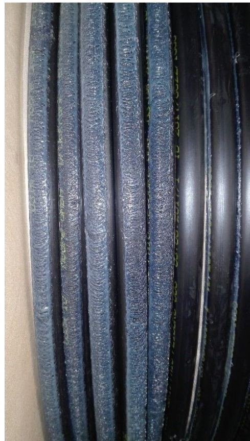
Abbildung 49: Klebeauftrag (links: Raupenauftrag ; rechts: Filmauftrag)
