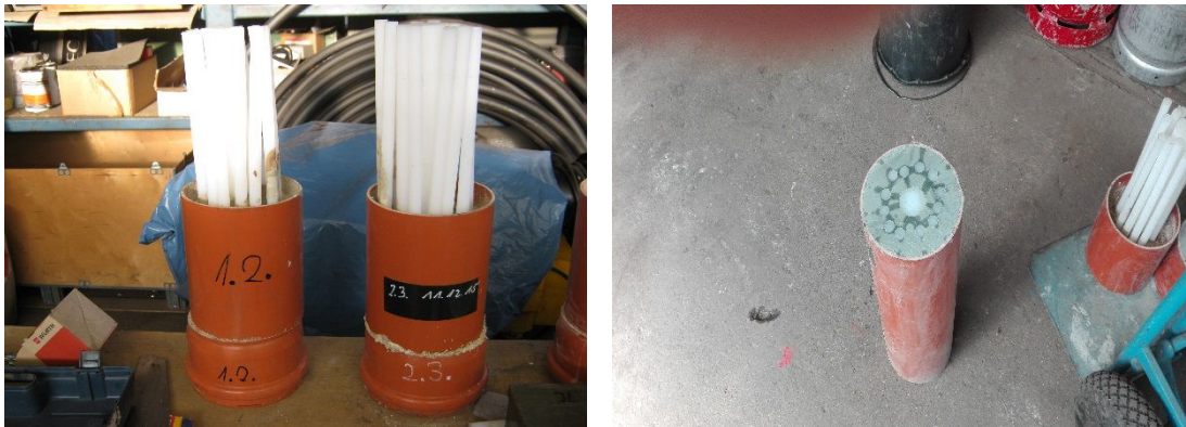
Abbildung 17: Ober- und Unterteil des Probekörpers nach Schnitt / fertiger Probekörper mit freigelegter Schnittkante
