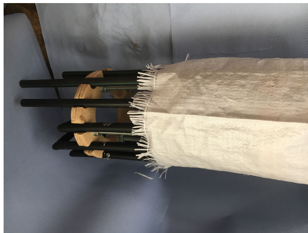
Abbildung 24: Einführen der Vorrichtung in den Gewebeschlauch
