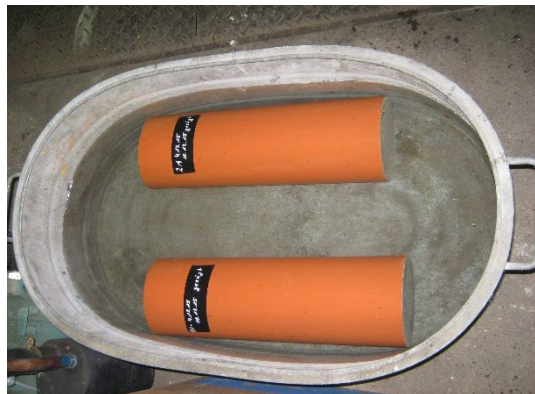
Abbildung 18: Lagerung der Probekörper im Wasserbad
