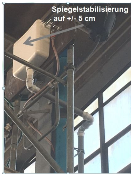
Abbildung 8: Niveauregulierung für die Wassersäule
