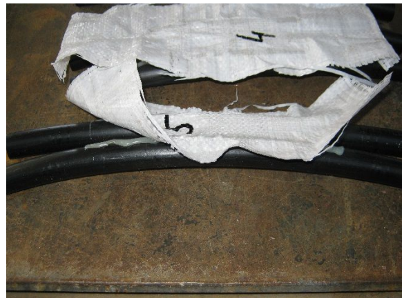
Abbildung 43: Begutachtung der Klebestelle / Versuch des Manuellen Lösens der Verklebung
