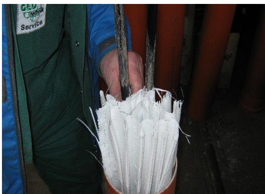
Abbildung 16: Einbringen der PE-Vollstäbe (beschichtet) / Zustand nach Einfüllen der Zementsuspension (linker Kunststoffzylinder)
