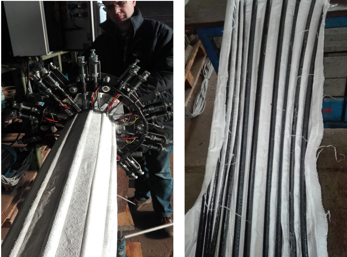
Abbildung 53: Während des Klebevorgangs / Qualitätskontrolle an einem aufgeschnittenen Probe- stück
