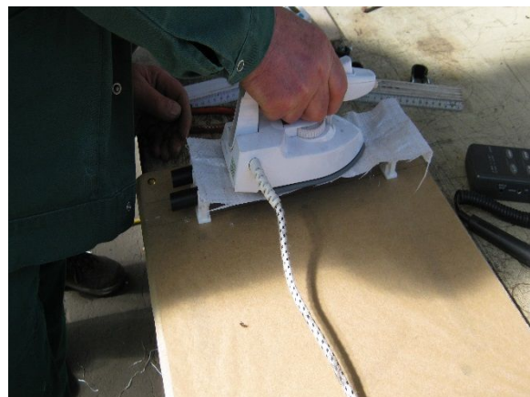
Abbildung 42: Rohrmuster mit Kleberauftrag / Manuelles Verkleben durch Wiederverflüssigung des Klebers mittels Wärmeeintrag
