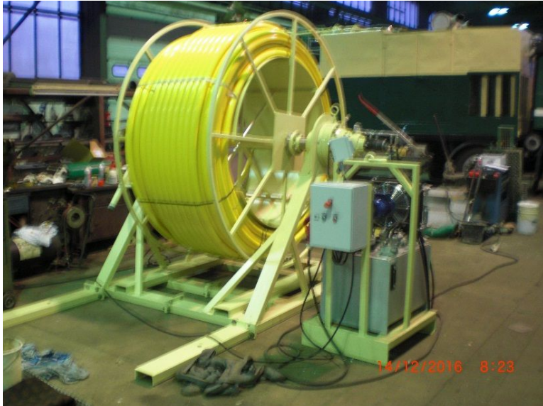
Abbildung 54: Aufwickel- und Transportvorrichtung (hydraulisch)
