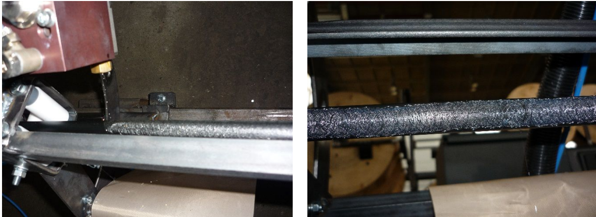
Abbildung 44: Filmauftrag (Vorgang) / fertiger Klebstoffauftrag
