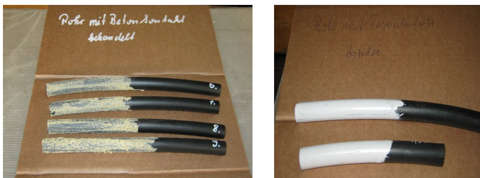
Abbildung 20: Rohre mit Betonkontakt (links) und Kunststofffarbe (rechts) behandelt
