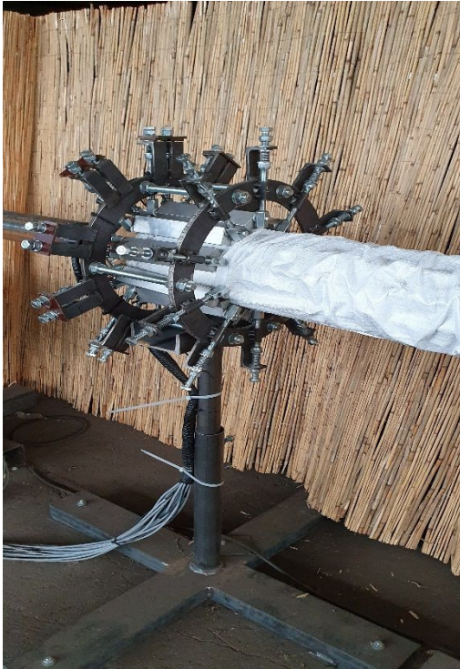
Abbildung 51: Mechanische Andruckvorrichtung mit Heizelementen zum Wiederaufheizen und Verkleben von Außenrohren und Gewebesack
