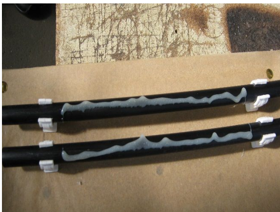
Abbildung 42: Rohrmuster mit Kleberauftrag / Manuelles Verkleben durch Wiederverflüssigung des Klebers mittels Wärmeeintrag
