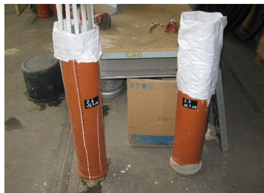
Abbildung 16: Einbringen der PE-Vollstäbe (beschichtet) / Zustand nach Einfüllen der Zementsuspension (linker Kunststoffzylinder)
