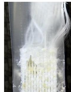
Abbildung 16: T-Schälversuch einer unzureichend imprägnierten Probe - Kraft-Weg-Diagramm (links) und Bruchbild (rechts)
