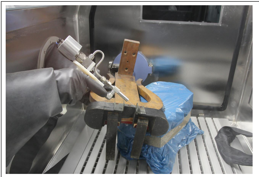
Abbildung 38: CO 2 -Reinigung der Lyra ( Video Reinigung Lyra ): ( Video Lyra-Pedal )
