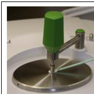
Abbildung 43: FTIR-ATR Spektrometer Messsituation
