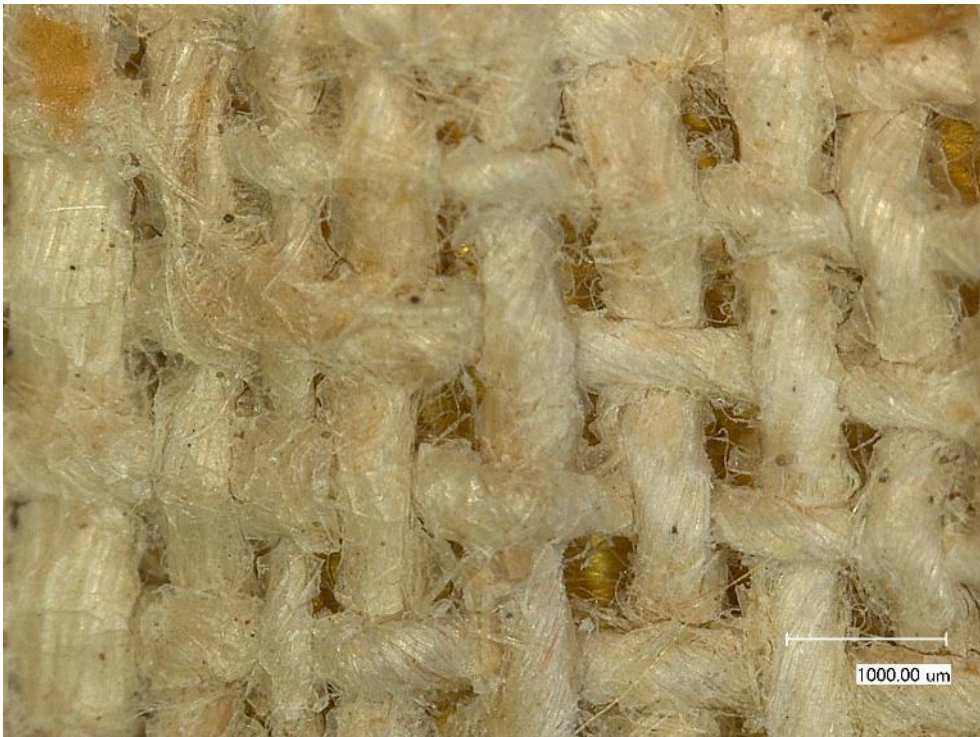
Abb. 99: Detailaufnahme des Zwischenfutters mit transparenter Stärkeappretur - Rückseite
