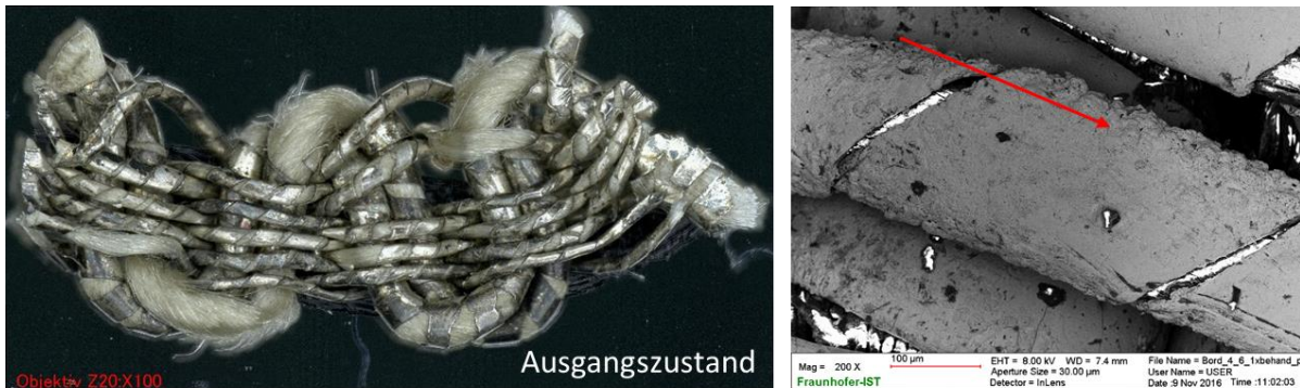
Abb. 23: Gereinigte Bordüre (links) und Blasenbildung auf dem Lahn (rechts)
