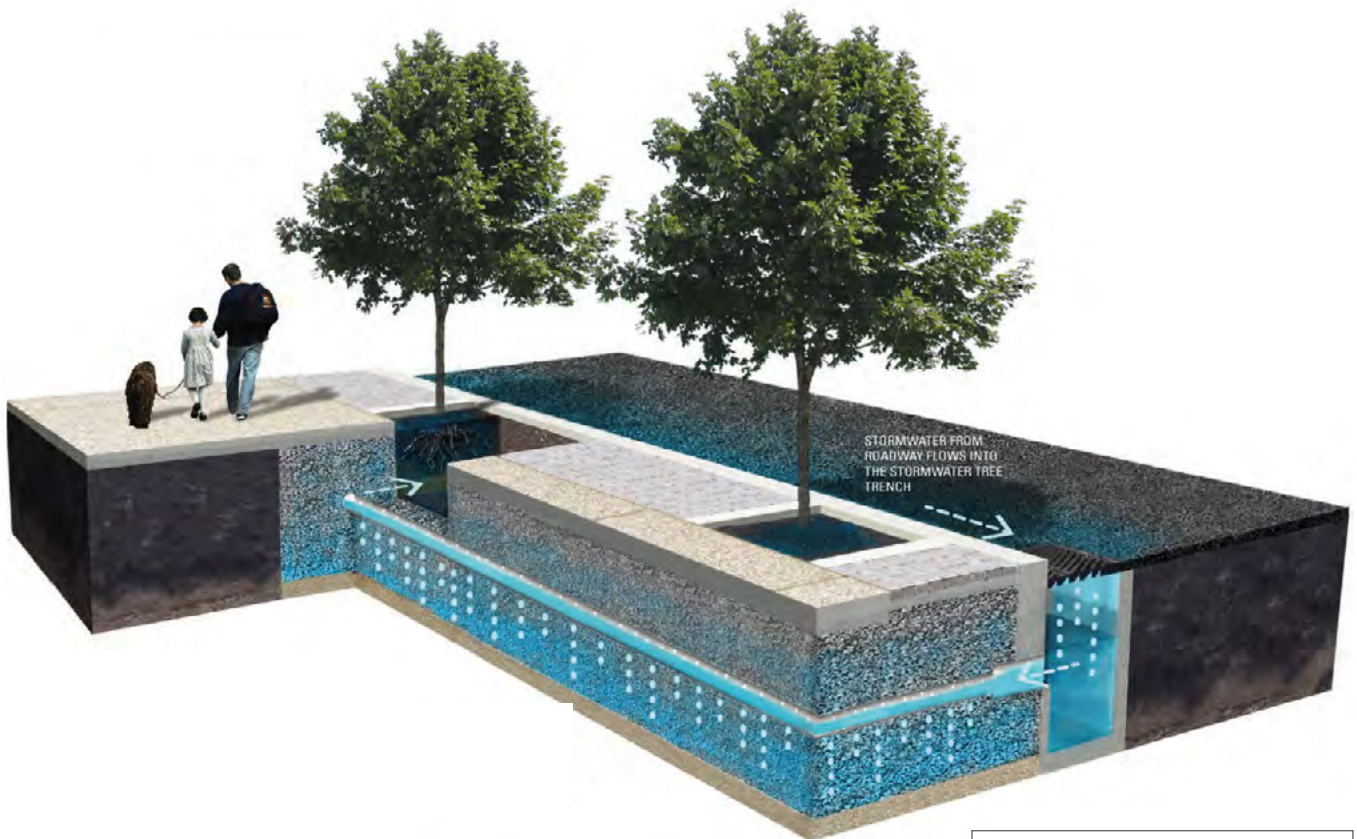
129 Funktionsprinzip einer Baumrigole
