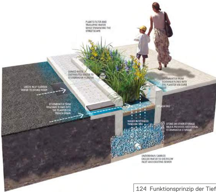
124 Funktionsprinzip der Tiefbeete
