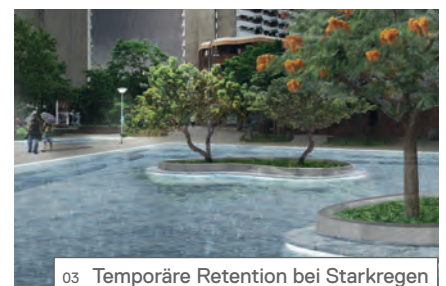
03 Temporäre Retention bei Starkregen
