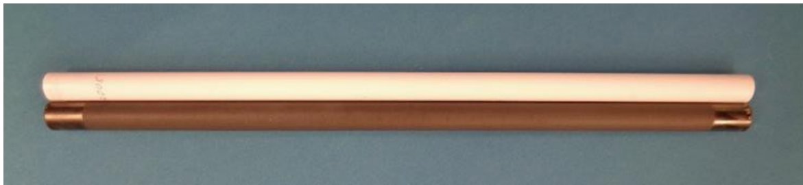
Abbildung 6: Ausgangskeramik – Trägermembran EKR (oben) sowie fertiger, infiltrierter Membranadsorber auf Basis eines EKR (unten)
