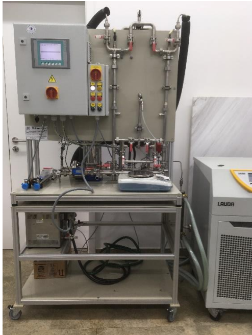
Abbildung 13: Adaptierte Versuchsanlage für die Testung der EKR-Membranadsorber (2 EKR mit max. 500 mm Länge)
