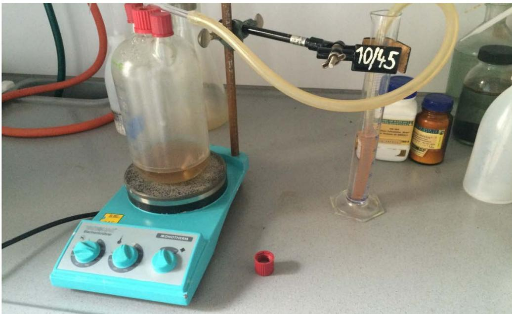
Abbildung 12: Laborapparatur zur Ammoniakausgasung
