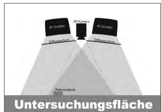
Messbereich von  $-40\text{ }^{\circ}\text{C}$  bis  $2000\text{ }^{\circ}\text{C}$  wird mit einer absoluten Messgenauigkeit von  $1,5\text{ }^{\circ}\text{C}$  aufgenommen und mit einer Pixel zu Pixel Relativauflösung von ca.  $0,03\text{ K}$  aufgelöst (InfraTec-GmbH, 2015).
