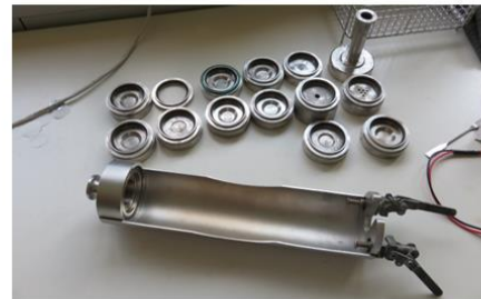
Low Pressure Impaktor mit 13 Stufen für die Korngrößenverteilung
