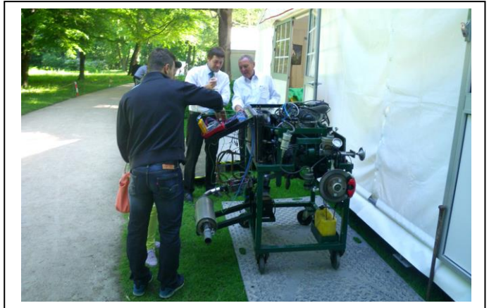
Abb. 25. PKW-Otto-Motor mit Thermo- elektrischer Nutzung der Abwärme
