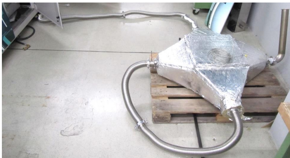
Abbildung 2.28: Versuchsaufbau für Voruntersuchungen zur Integration des Wärmetauschers in das Gesamtanlagenkonzept
