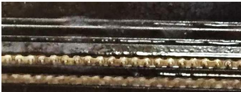
Abbildung 2.15: Ölrückstände an der Transportkette nach einem Test bei 270°C/ 30 Tage
