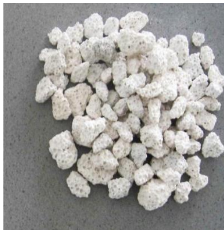
Abbildung 2.18: Filtergranulat des thermischen Reaktors
