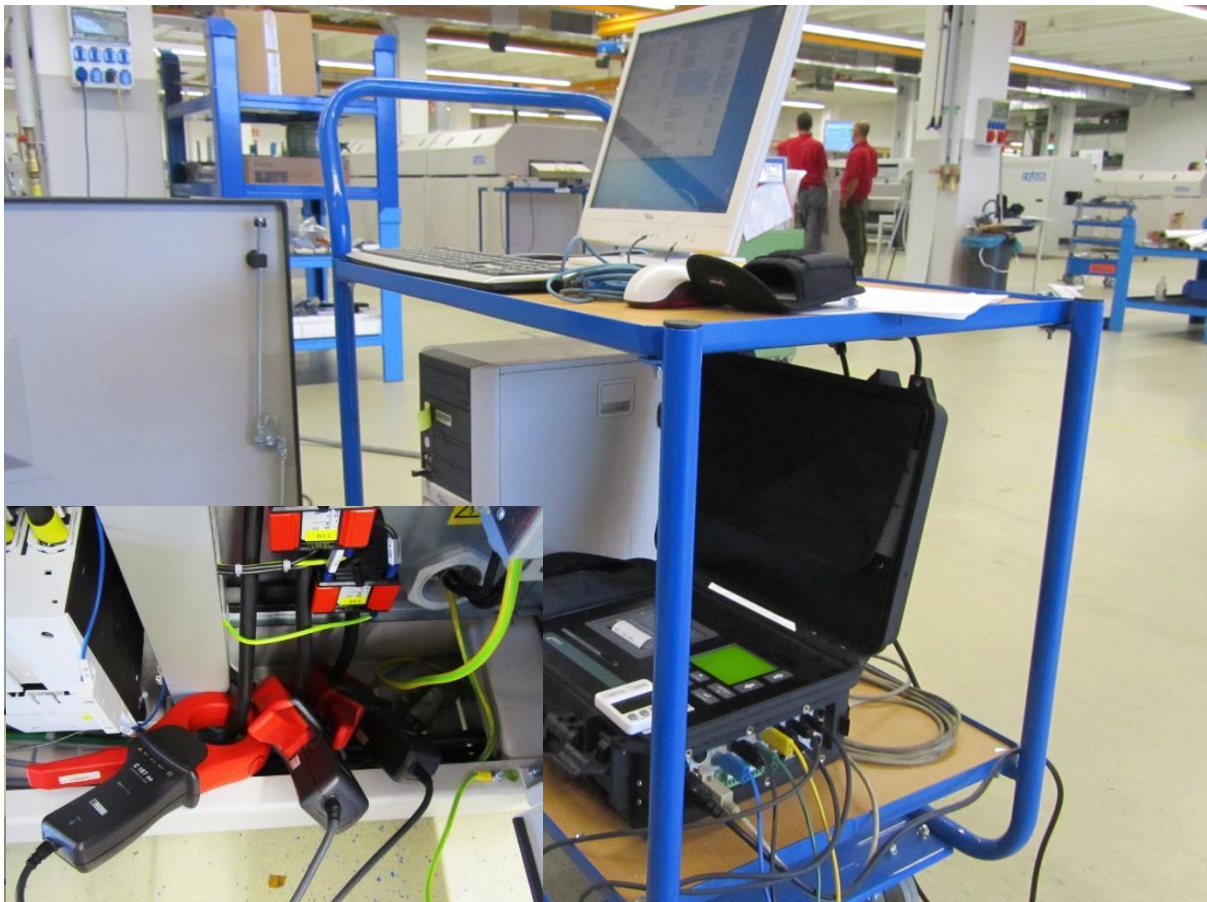
Abbildung 2.33: Versuchsaufbau zum Erfassen des Energieverbrauchs an der Vakuumkonvektionslötanlage
