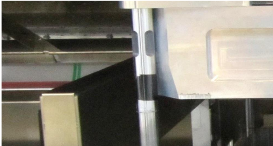
Abbildung 2.9: Verbindung der Vakuumkammer mit den Hubzylindern
