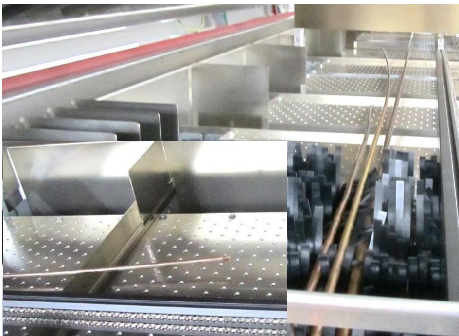
Abbildung 2.30: Positionierung der Messslanzen zum Transfer der Atmosphäre aus den jeweiligen Zonen zum FID-Messgerät
