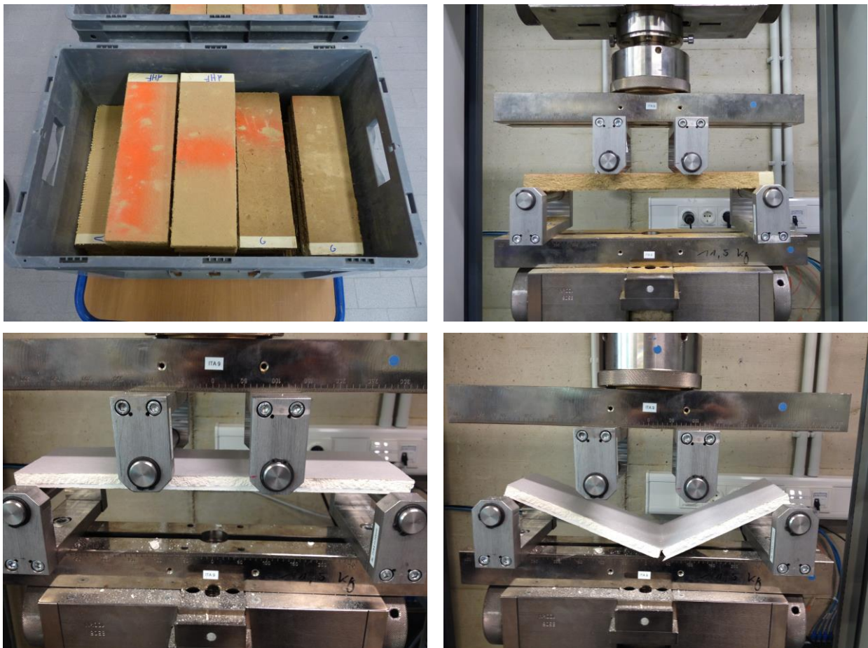
Abbildung 14: 4-Punkt-Biegeprüfung der Lehmbauplatten (oben) und Rigipsplatten (unten) am ITA
