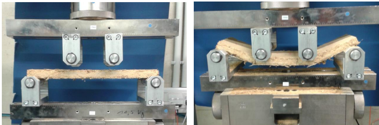
Abbildung 5: Prüfaufbau vor (links) und nach (rechts) dem 4-Punkt-Biegeversuch nach DIN EN 1170-5
