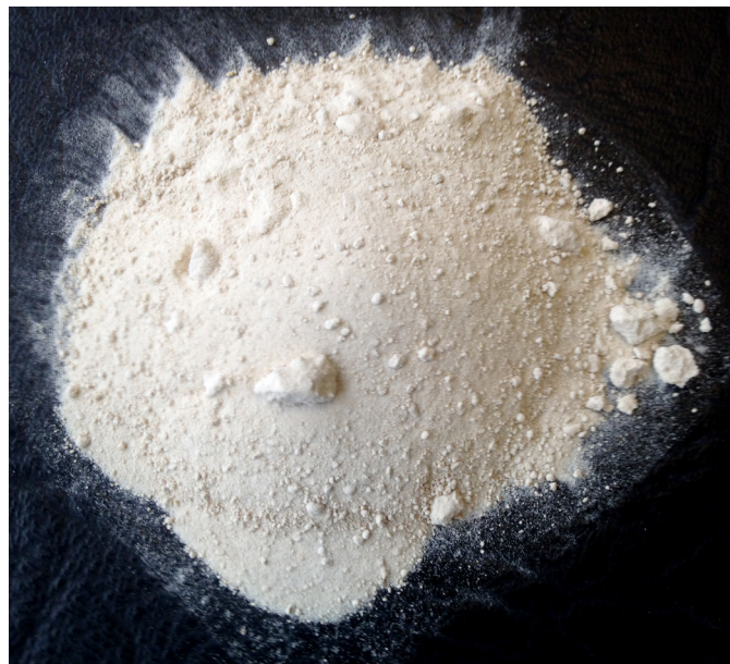
Abb. 5-3: MAP-Fällungsprodukt aus Gärreste-Prozesswasser (pH 8)
