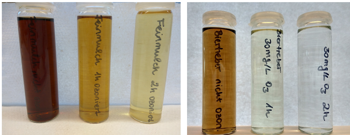
Abb. 8-17: Auswirkung der Ozonung auf die Färbung von biologisch vorbehandeltem Feinmulch- (links) und Biertreber-Prozesswasser (rechts)
