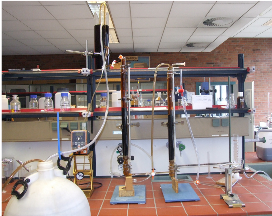
Abb. 8-10: Versuchsaufbau für die Kolonnenversuche
