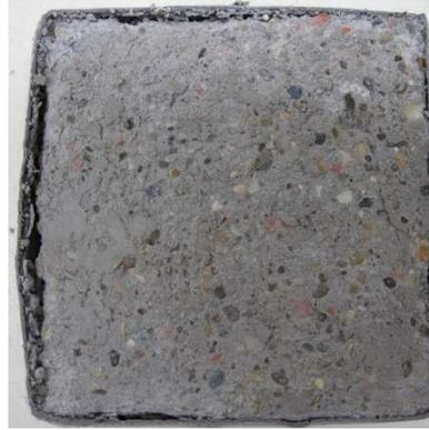
Abb. 166: R-Betonprobe DR 35 nach der CIF Prüfung
