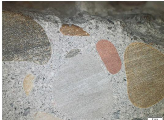
Abb. 59: Oberfläche DN 38 nach dem CDF-Test, 6-fache Vergrößerung
