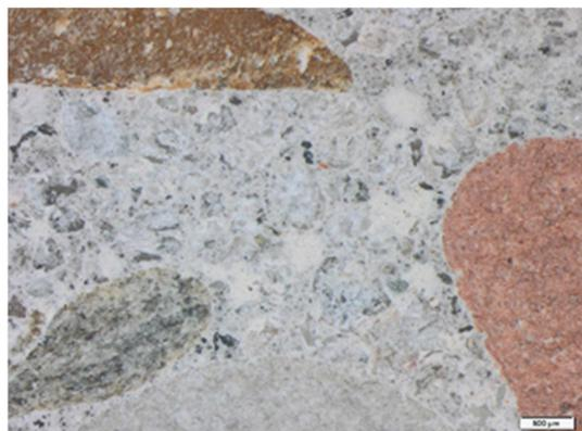
Abb. 61: Oberfläche DN 38 nach dem CDF-Test, 25-fache Vergrößerung
