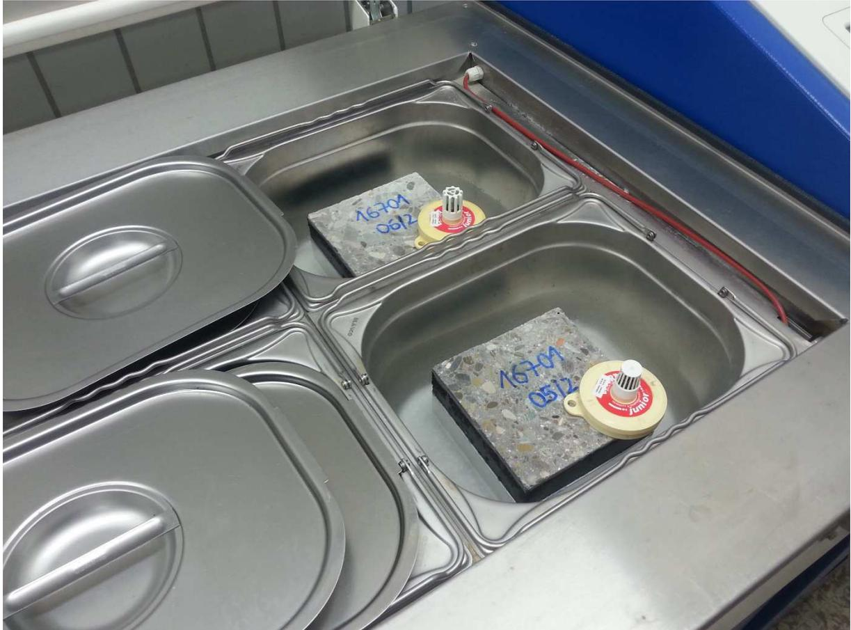
Abb. 173: Truhe für die Frostprüfungen (Labor Fa. Holcim, Dotterhausen)
