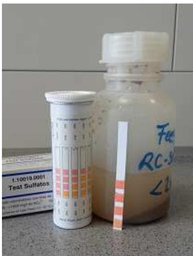
Abb. 41: Sulfat-Schnelltest mit Stäbchen
