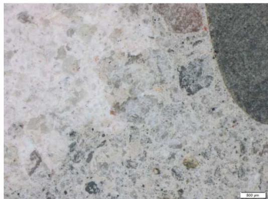
Abb. 53: Oberfläche DR 35 nach dem CDF-Test, 25-fache Vergrößerung
