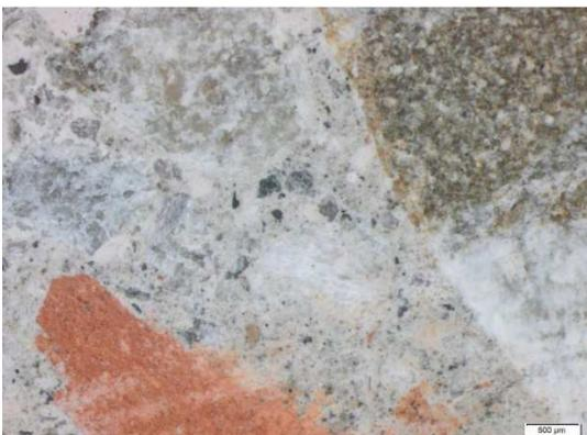
Abb. 52: Oberfläche DR 28 nach dem CDF-Test, 25-fache Vergrößerung
