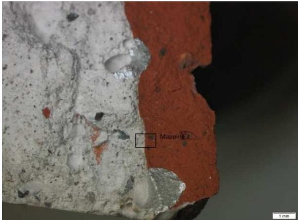
Abb. 72: lichtmikroskopische Aufnahme Ökosteine, Verbundbereich Zementstein-Ziegelgesteinskorn, eingezeichnete Stelle der REM/EDX Analyse, Vergrößerung 10-fach
