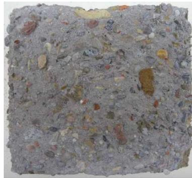
Abb. 49: Oberfläche DR 35 nach dem CDF-Test
