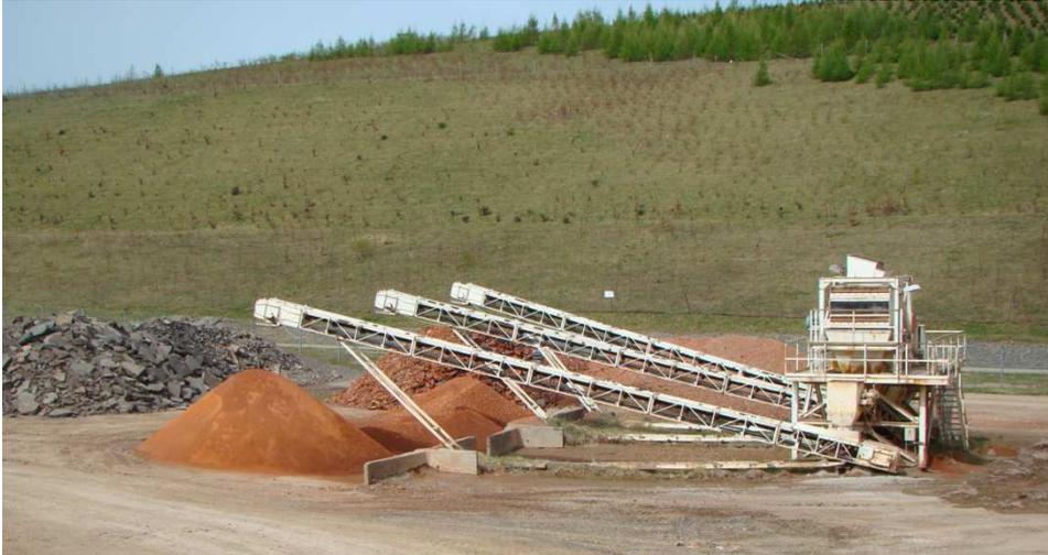
Abb. 14: Siebstation in einer stationären Recyclinganlage <sup>5</sup>
