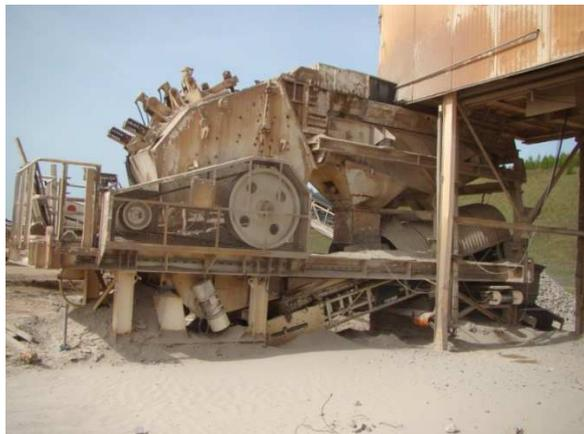
Abb. 13: Prallbrecher in einer stationären Bauschutttaufbereitungsanlage <sup>4</sup>
