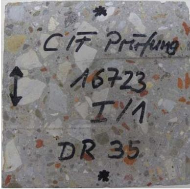
Abb. 165: R-Betonprobe DR 35 vor der CIF Prüfung
