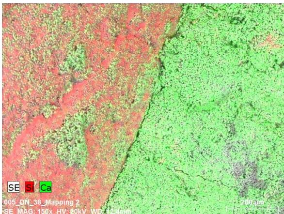
Abb. 97: EDX Analyse DN 38, Verbundbereich Zementstein-Gesteinskorn, rot-Silicium (Gesteinskorn), grün-Calcium (Zementstein), Vergrößerung 150-fach
