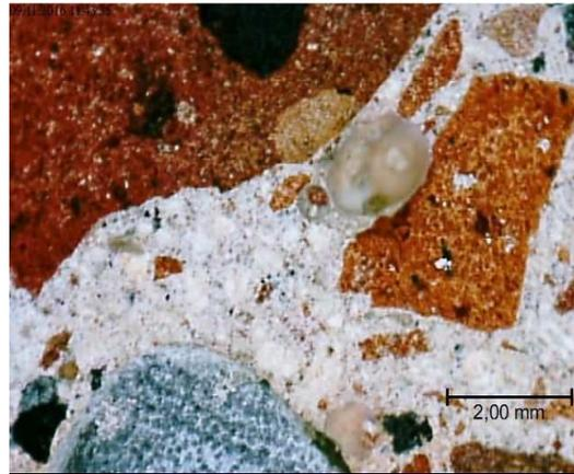
Abb. 132: Lichtmikroskopische Aufnahme der R-Betonstütze
