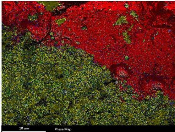
Abb. 68: EDX Analyse DR 35, Verbundbereich Zementstein-Ziegelgesteinskorn, rot-Silicium (Ziegelgesteinskorn), grün-Calcium (Zementstein), Vergrößerung 400-fach
