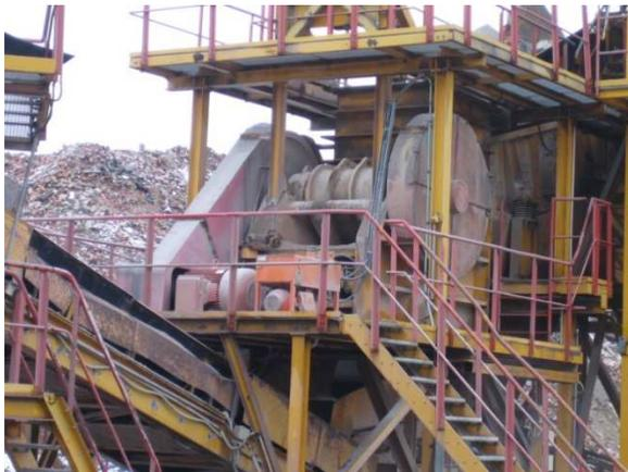
Abb. 12: Backenbrecher in einer stationären Bauschutttaufbereitungsanlage <sup>3</sup>
