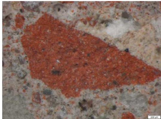
Abb. 148: Lichtmikroskopische Analyse eines Mörtels mit RC-Sand, Detail vergrößert
