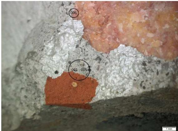
Abb. 66: lichtmikroskopische Aufnahme DR 35, Verbundbereich Zementstein-Ziegelgesteinskorn, eingezeichnete Stelle der REM/EDX Analyse, Vergrößerung 10-fach
