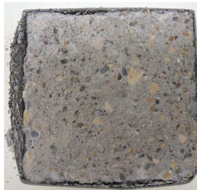
Abb. 172: Referenzbetonprobe DN 38 nach der CIF Prüfung
