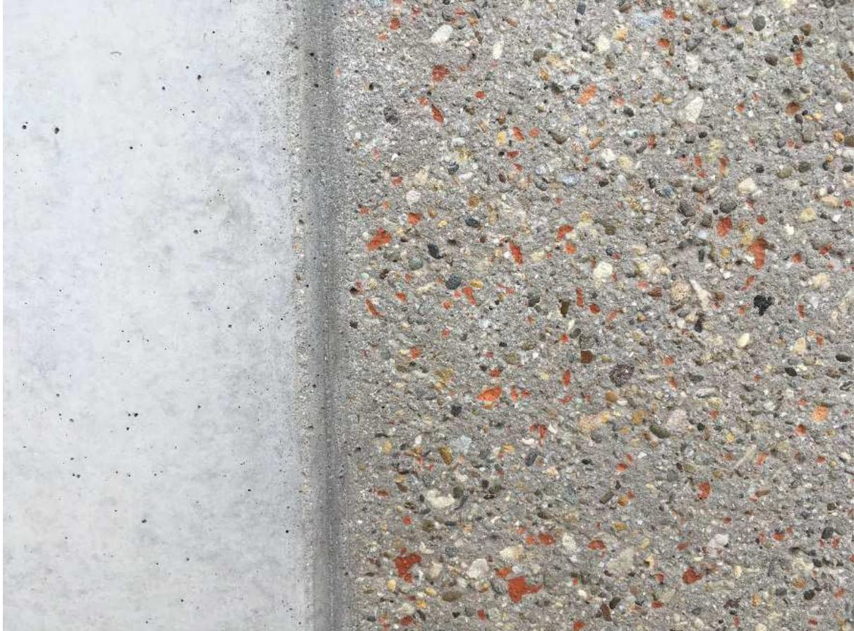
Abb. 136: Links: Oberfläche eines R-Betons mit Typ 2 geschalt, rechts: gleicher R-Beton nach dem Sandstrahlen
