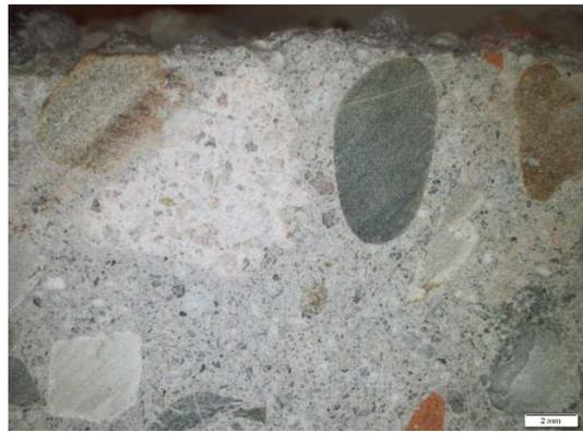
Abb. 51: Oberfläche DR 35 nach dem CDF-Test, 6-fache Vergrößerung
