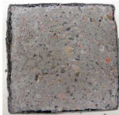
Abb. 168: R-Betonprobe DR 38 nach der CIF Prüfung
