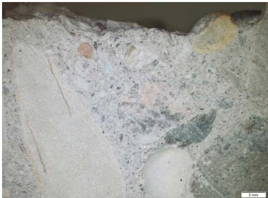
Abb. 58: Oberfläche DN 35 nach dem CDF-Test, 6-fache Vergrößerung
