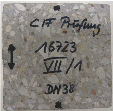
Abb. 171: Referenzbetonprobe DN 38 vor der CIF Prüfung
