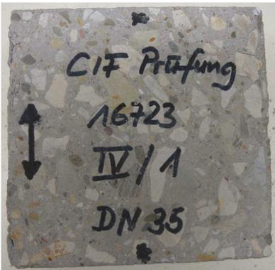
Abb. 169: Referenzbetonprobe DN 35 vor der CIF Prüfung
