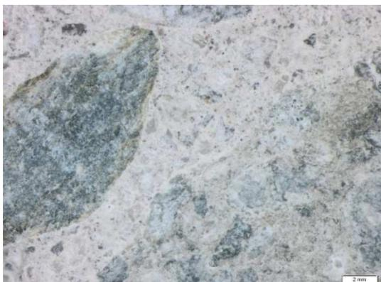
Abb. 60: Oberfläche DN 35 nach dem CDF-Test, 25-fache Vergrößerung
