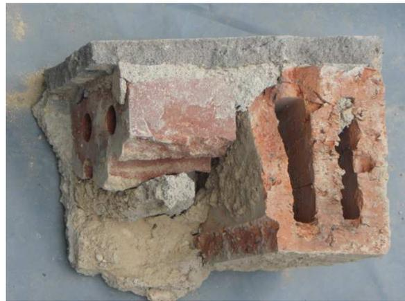
Abb. 11: Mauerwerkbruch nach der Zerkleinerung (links) und Verbundpartikel Ziegel mit anhaftendem Mörtel (rechts) <sup>2</sup>
