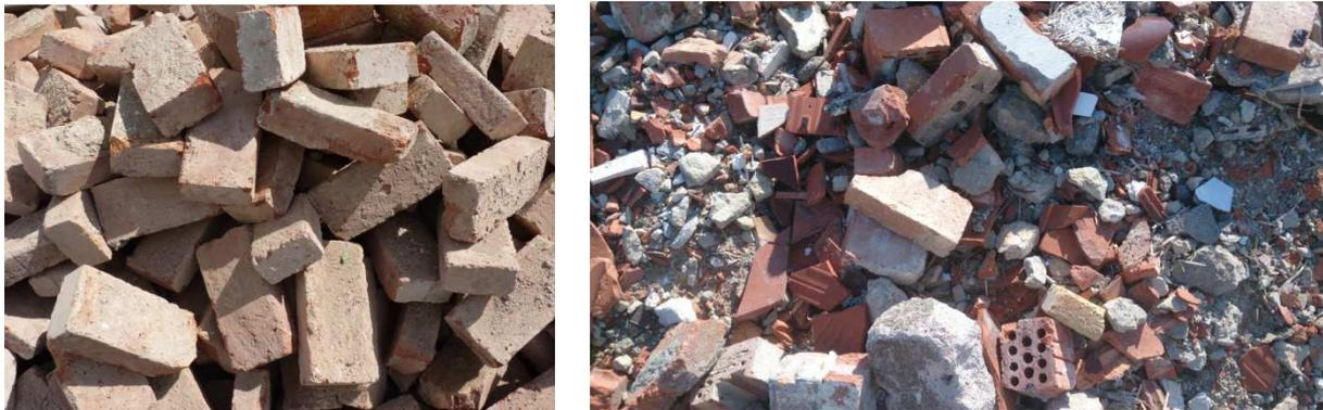
Abb. 10: Sortenreiner Ziegelbruch (links) bzw. Mauerwerkbruch (rechts) als Ausgangsmaterialien für die Herstellung von Ziegelrezyklaten <sup>1</sup>
