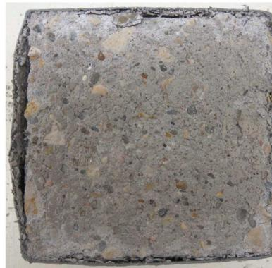
Abb. 170: Referenzbetonprobe DN 35 nach der CIF Prüfung
