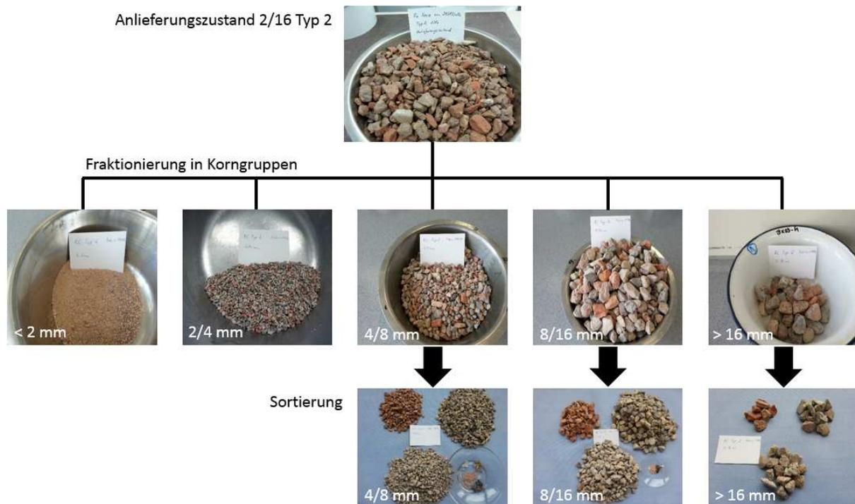
Abb. 29: Fraktionierung und stoffliche Sortierung einer RC-Gesteinskörnung
