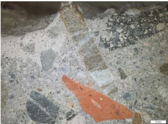
Abb. 50: Oberfläche DR 28 nach dem CDF-Test, 6-fache Vergrößerung
