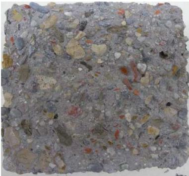
Abb. 48: Oberfläche DR 28 nach dem CDF-Test
