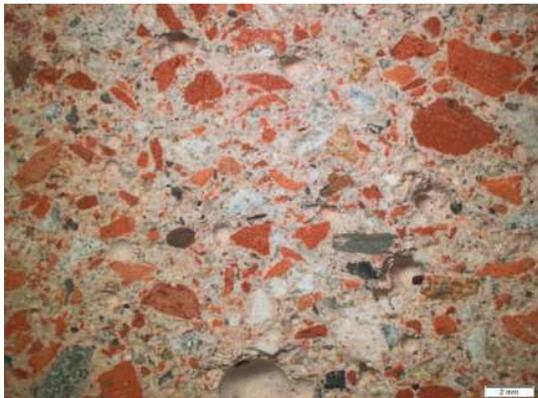
Abb. 147: Lichtmikroskopische Analyse eines Mörtels mit RC-Sand
