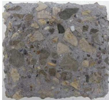
Abb. 57: Oberfläche DN 38 nach dem CDF-Test
