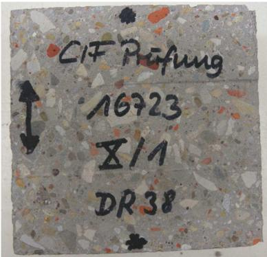
Abb. 167: R-Betonprobe DR 38 vor der CIF Prüfung
