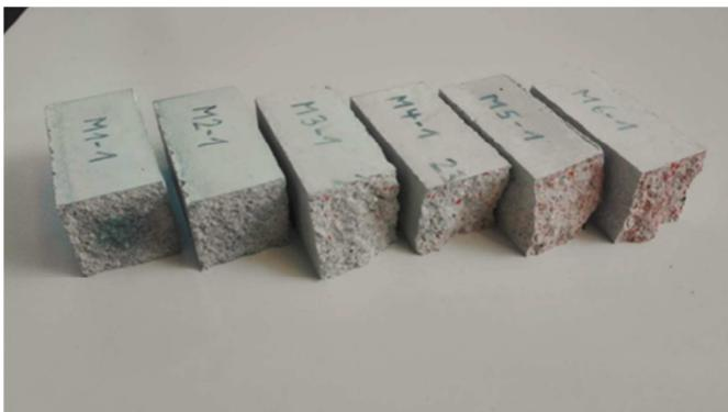
Abb. 145: Bruchflächen der Mörtelprismen, von links: Proben 1 und 2 mit Normsand, Proben 3 bis 6 mit RC-Sanden
