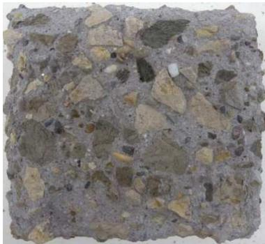
Abb. 56: Oberfläche DN 35 nach dem CDF-Test
