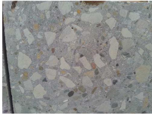
Abb. 55: Oberfläche DN 38 vor dem CDF-Test
