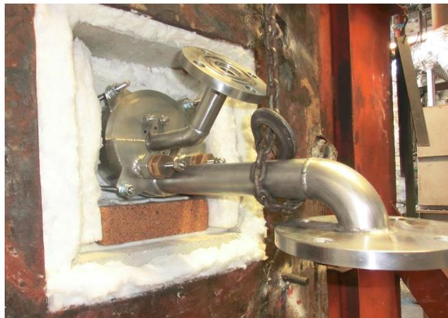
b) Oxy-Fuel-Brenner am GWI-Versuchssofen montiert
