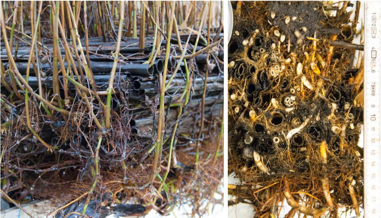
Abbildung 18. Durchwachsener Schilfrohrgabionenkörper im dritten Entwicklungsjahr in der Ansicht (a) und im Schnitt (b). Die Halme der Schilfrohrgabione sind zu erkennen. Die Durchwurzelung findet sowohl in den Halmzwischenräumen als auch im Inneren der Halme statt. Sowohl dadurch als auch durch die Feinwurzeln ließen sich zahlreiche Halme nicht mehr aus der Schilfrohrgabione herausziehen und waren daher zu einem Körper zusammen gewachsen.
