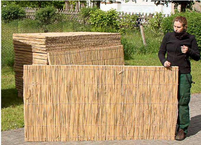
Abbildung 23. Schilfrohrplatte mit einer Kantenlänge von 1 x 1 m. Aus der Platte konnten die Halme mit einer Länge von 1 m entnommen werden.
