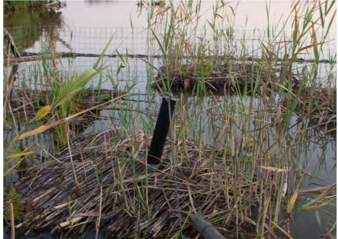
Abbildung 40. Eingesetzte Sauerstoffsonde im Zentrum der Schilfrohgabione.
