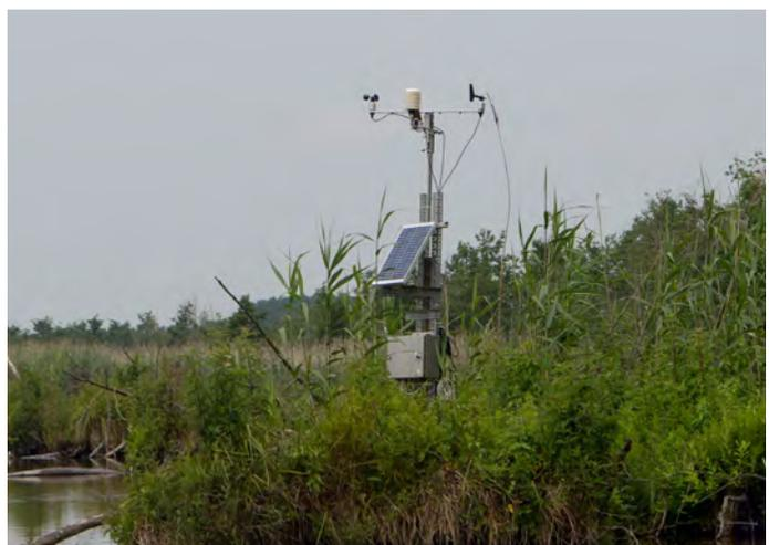
Abbildung 42. Wetterstation an der Kante des Schwingröhriches (v.l.n.r: Windgeschwindigkeit, Lufttemperatur und Feuchte, Windrichtung; Wassertemperatur nicht zu erkennen; Solarpanele in der Mitte mit Datenloggergehäuse darunter).
