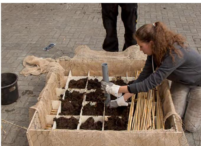
Abbildung 27. Auffüllen der Kammerung mit Schilftorf und Einbau der nächsten Lage Schilfrohrhalme. In die Mitte wird das Kunststoffrohr zur Sauerstoffmessung in der Kammerung eingesetzt.
