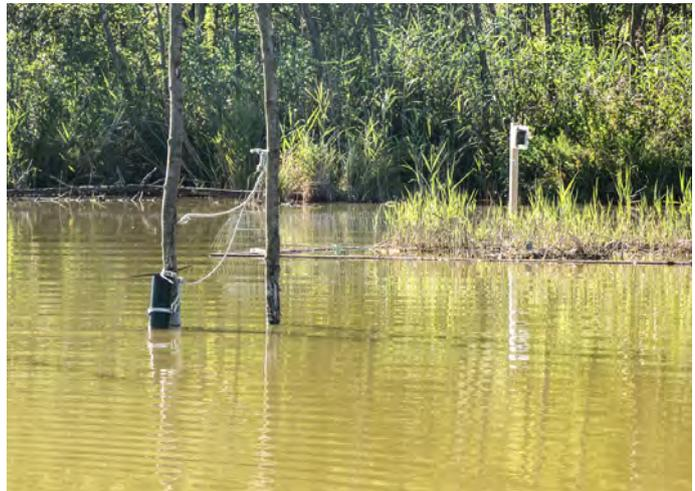
Abbildung 41. Installierte Drucksonde an zwei ca. 4 m tief im Seegrund fest verankerten Stangen.
