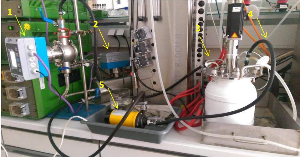
Abbildung 15. Versuchsanordnung mit eingebundenen Sensoren. 1: Schallsensor Sonatec, 2: Dichtesensor Rhotec, 3: Reaktorablauf, 4: Reaktorzulauf, 5: Umwälzpumpe
