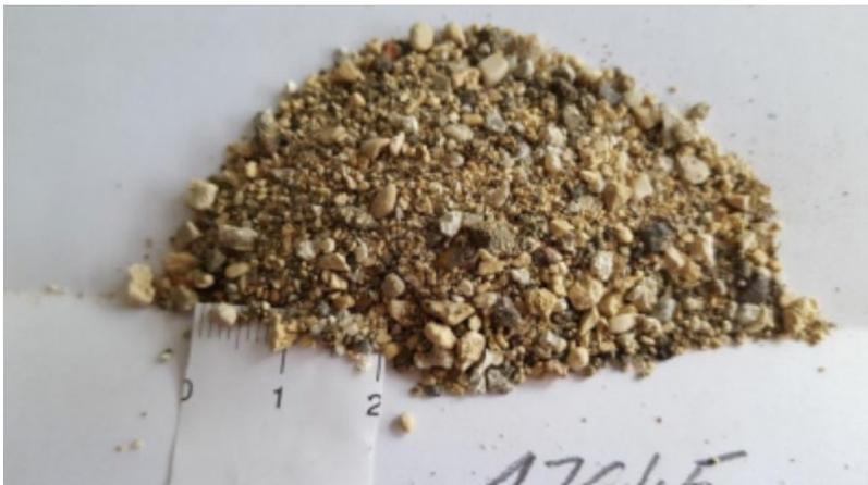
Abbildung 21: Aufgabematerial Boden-Bauschutt-Gemisch: Sande (Probe 17645)
