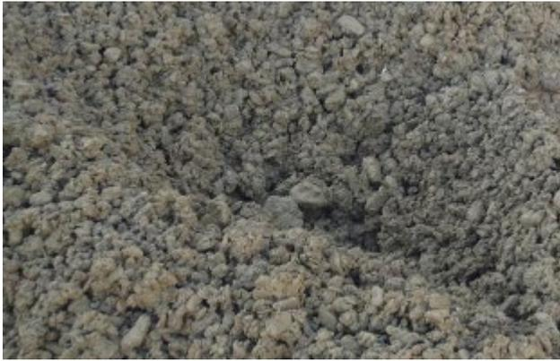
Abbildung 3: Bodenaushub aus Kalk-Mergel
