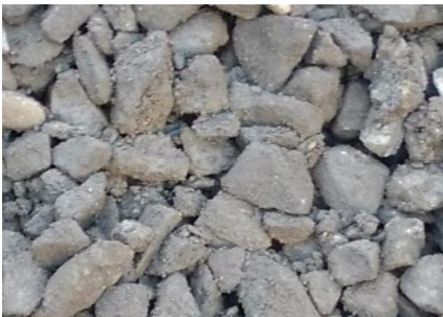
Abbildung 2: Gleisschotter mit Mikroplastik
