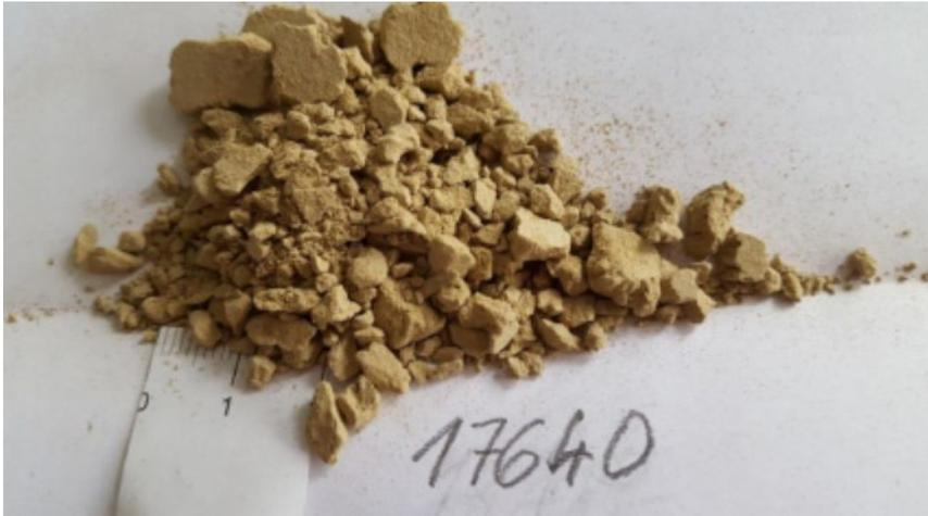
Abbildung 19: Aufgabematerial Boden-Bauschutt-Gemisch: Getrockneter Schluff (Probe 17640)
