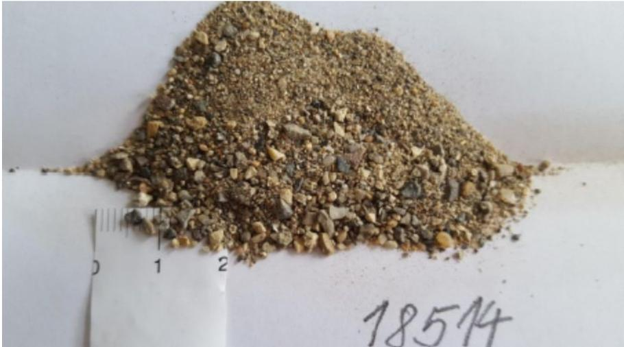
Abbildung 22: Aufgabematerial Boden-Bauschutt-Gemisch: Sande (Probe 18514)
