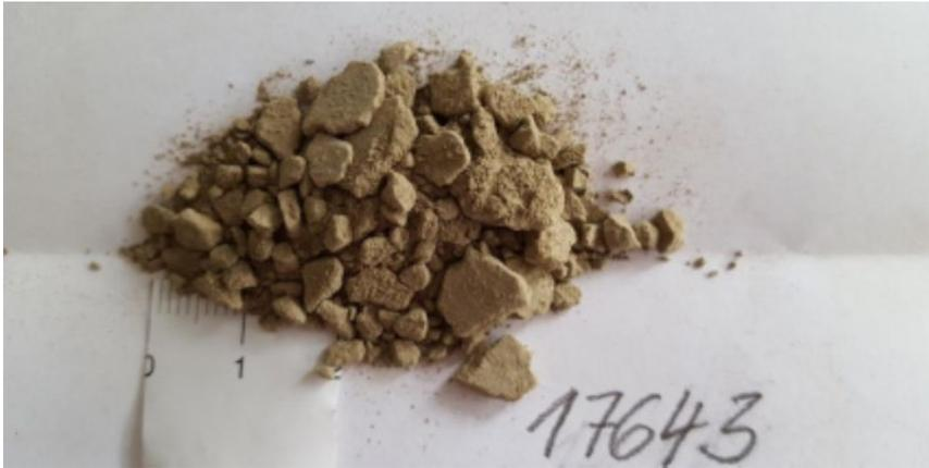
Abbildung 16: Aufgabematerial Gleisschotter: Getrockneter Schluff (Probe 17643)
