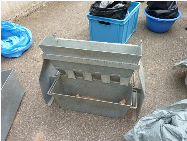
Abbildung 5: Probenteilung mit Riffelteiler
