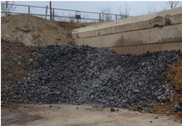
Abbildung 1: Aufgabematerial Gleisschotter
