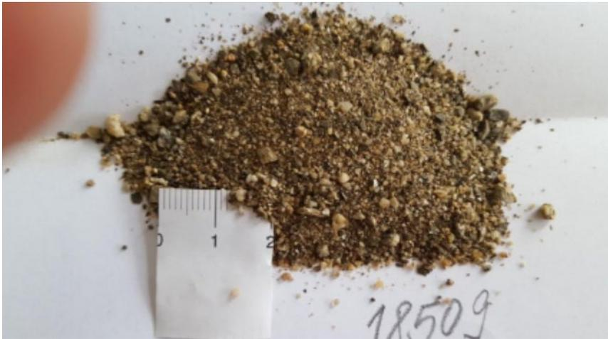
Abbildung 18: Aufgabematerial Gleisschotter: Sande (Probe 18509)
