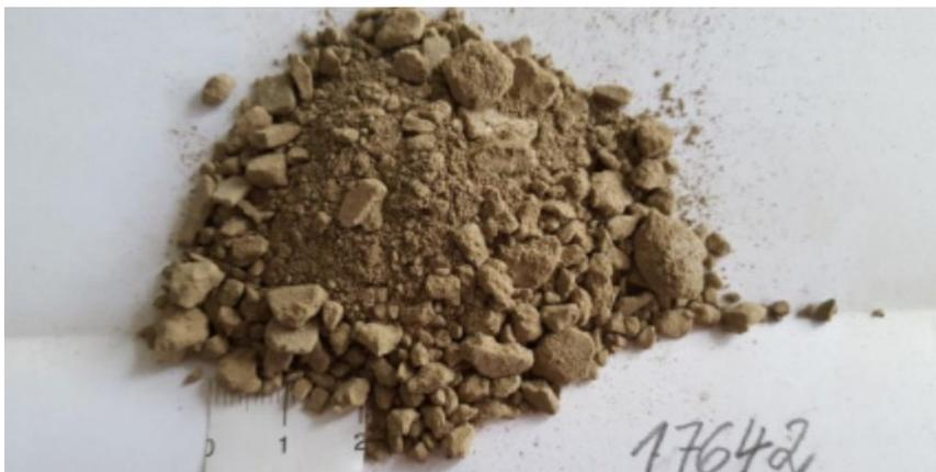
Abbildung 15: Aufgabematerial Gleisschotter: Getrockneter Schluff (Probe 17642)
