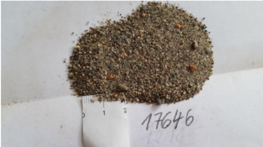
Abbildung 17: Aufgabematerial Gleisschotter: Sande (Probe 17646)
