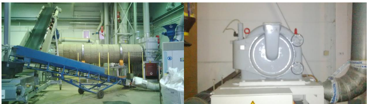
Abbildung 13: Trommeltrockner (links) und Feinprallmühle (rechts) [13]
