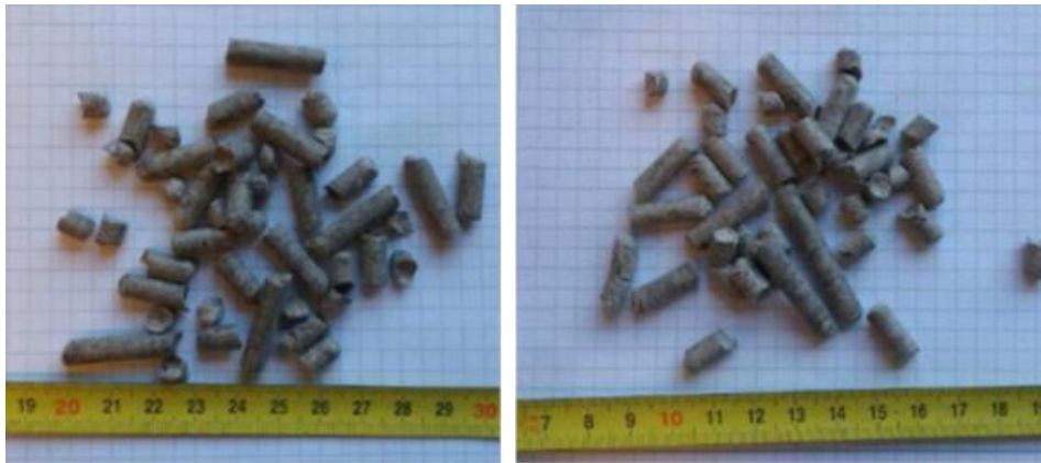
Abbildung 15: V1 – 100 % FS grob (SD: 612 kg/m 3 , links), V2 – 100 % FS fein (SD: 632 kg/m 3 , rechts) [13]
