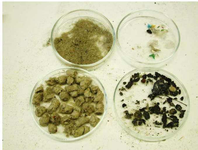
Abbildung 7: Magnettrommelsortierung: oben Faserstaub und Plasteteile; unten F-Pellets und Metallteile
