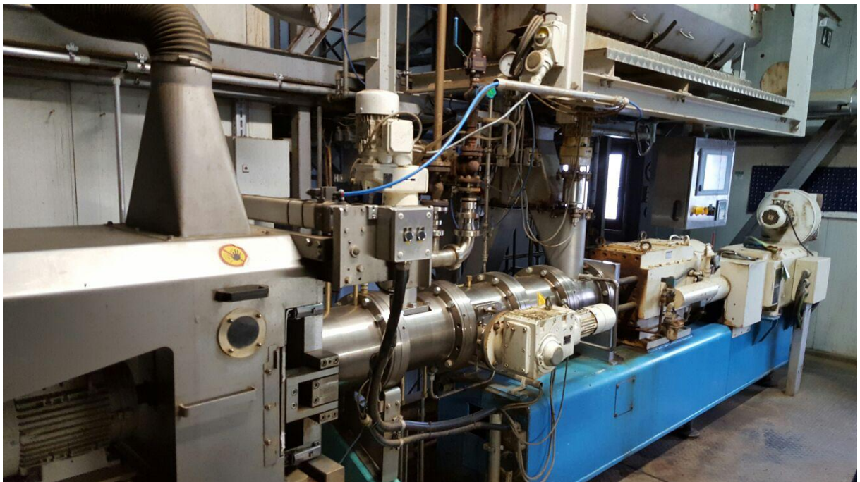
Abbildung 3: Bühler Doppelwellenextruder mit einem Wellendurchmesser von 93 mm (Quelle: Gründleinsmühle)
