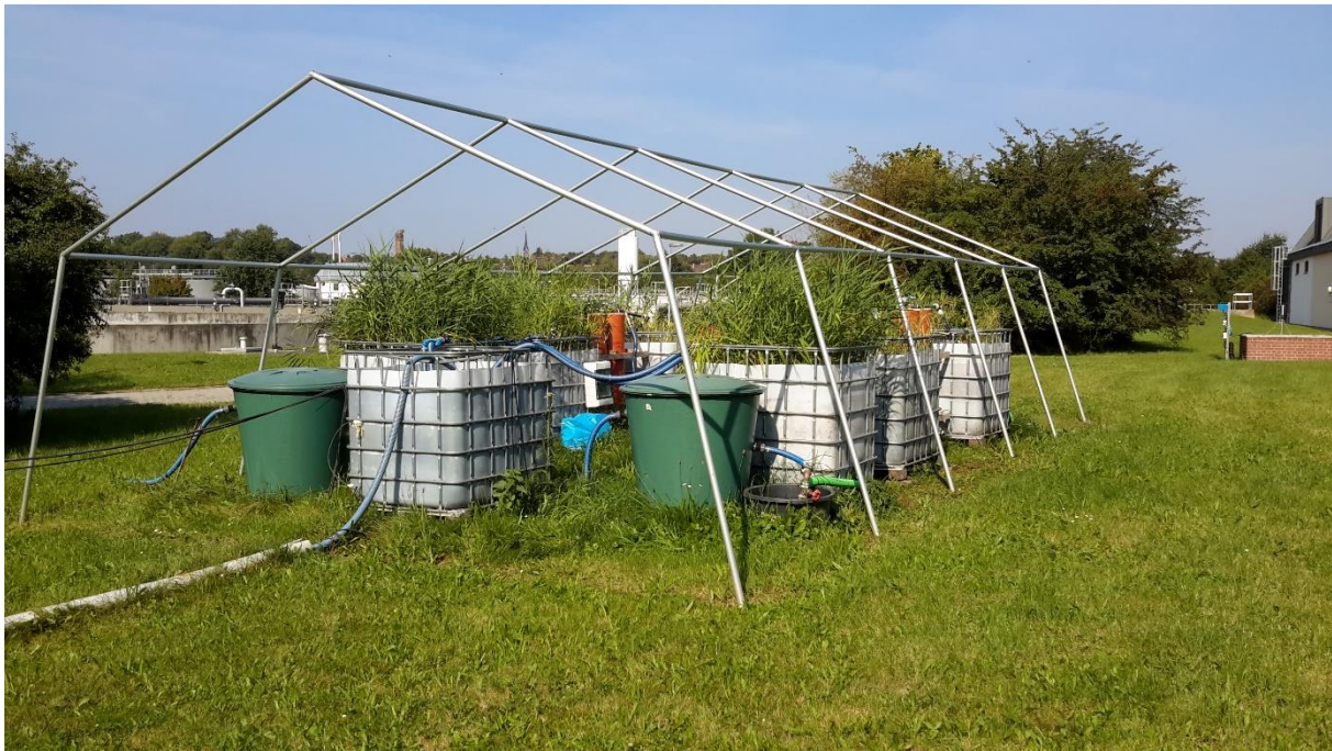
Abbildung 7: Versuchs-Pflanzenkläranlagen des Projekts (Foto A. Klüttig)
