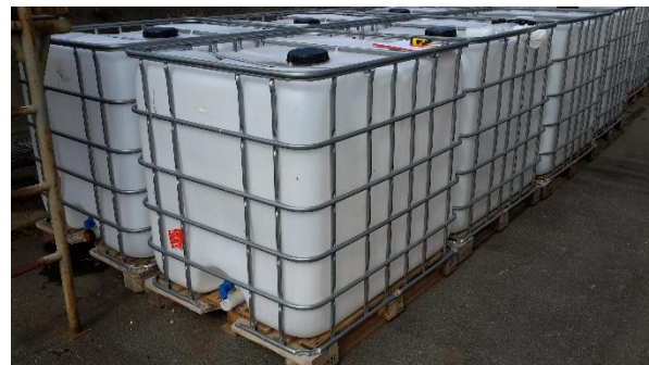
Abbildung 3: IBC-Tank vor Umarbeitung (Foto A. Kluttig)
