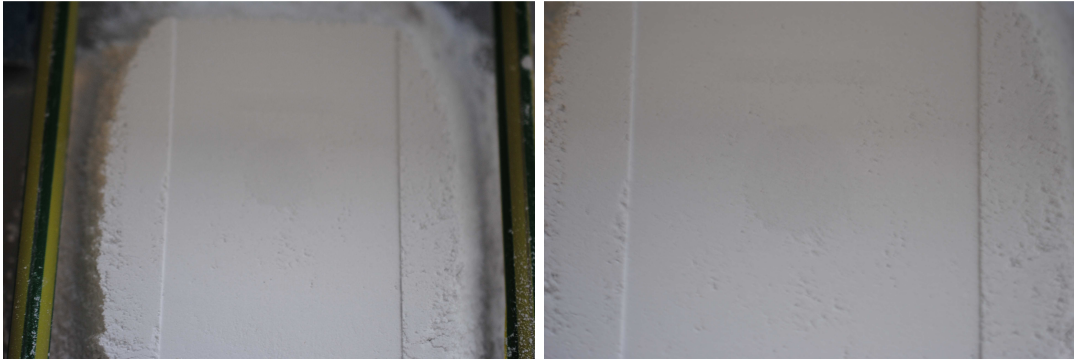
Abbildung 28: Druckversuche mit WZR-Forschungsdrucker. Darstellung des Pulverbettes mit Tropfenabstand: 0,14mm, Linienabstand: 0,12mm
