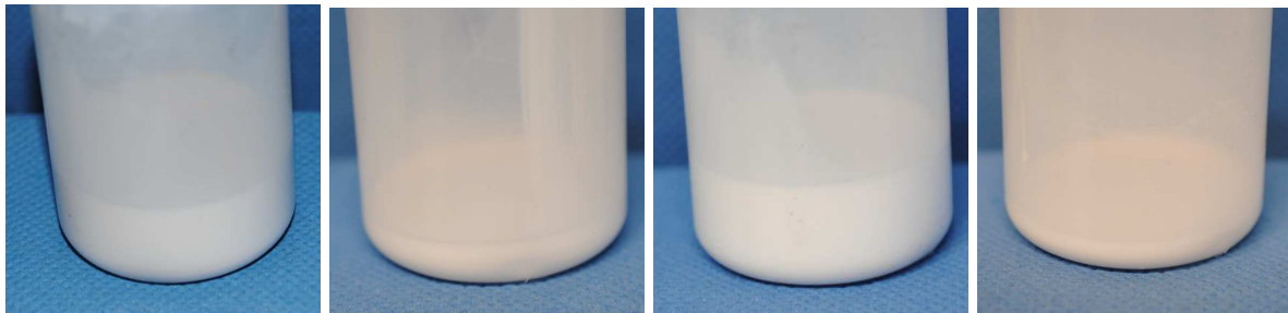
Abbildung 55: Tinten ohne Binder, Gehalt an Additiv A-5 von links nach rechts: 2,0; 2,5; 3,0; 5,0
