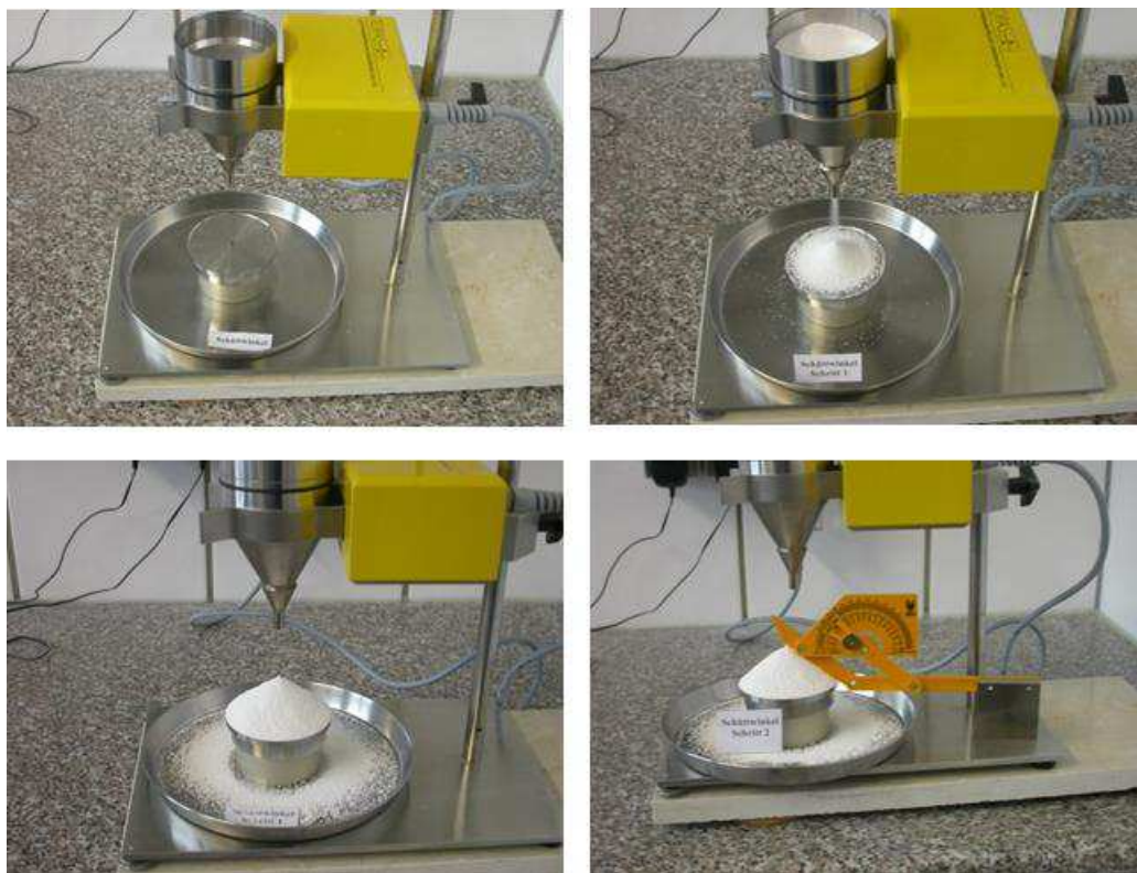
Abbildung 1: Aufbau zur Messung der Schüttdichte und des Schüttwinkels
