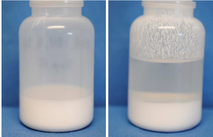
Abbildung 53: ZrO 2 -Tinte links ohne Binder, rechts mit Binder
