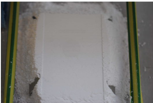
Abbildung 27: Druckversuche mit WZR-Forschungsdrucker. Darstellung des Pulverbettes Tropfenabstand: 0,16mm, Linienabstand: 0,14mm.
