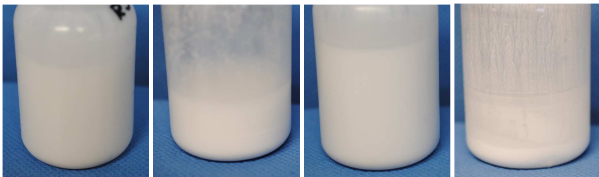
Abbildung 56: Tinten mit Binder, Gehalt an Additiv A-5 von links nach rechts: 2,0; 2,5; 3,0; 5,0
