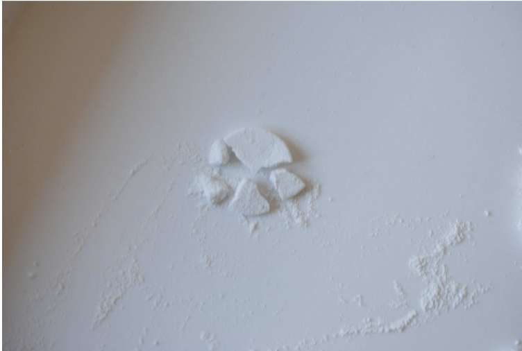
Abbildung 26: Druckversuche mit WZR-Forschungsdrucker. Darstellung der entformten Probe. Tropfenabstand: 0,14mm, Linienabstand: 0,12mm.
