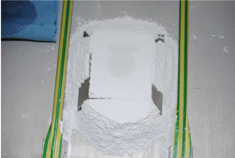
Abbildung 22: Druckversuche mit WZR-Forschungsdrucker. Darstellung des Pulverbettes Tropfenabstand: 0,08mm, Linienabstand: 0,07mm.
