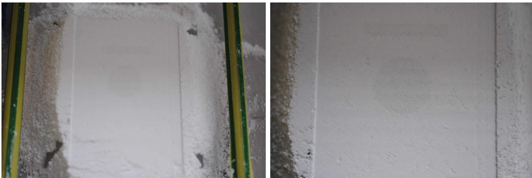
Abbildung 25: Druckversuche mit WZR-Forschungsdrucker. Darstellung des Pulverbettes Tropfenabstand: 0,14mm, Linienabstand: 0,12mm.
