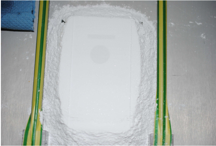
Abbildung 24: Druckversuche mit WZR-Forschungsdrucker. Darstellung des Pulverbettes Tropfenabstand: 0,12mm, Linienabstand: 0,10mm.
