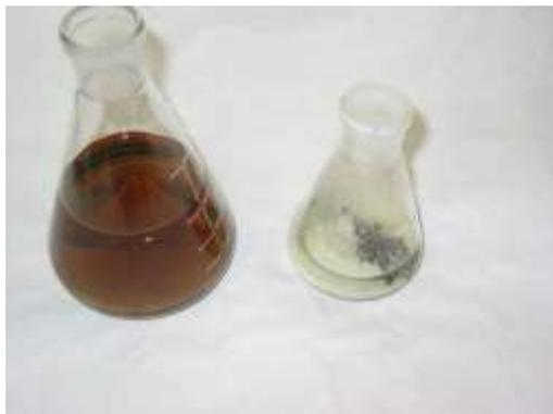
Abbildung 5: Hydrolyselösung links vor und rechts nach Behandlung mit Eisen­spänen
