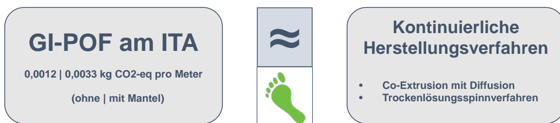
Abbildung 2.19: Qualitativer Vergleich des CO 2 -Fußabdrucks von GI-POF aus verschiedenen kontinuierlichen Verfahren (vgl. [www15a]).
