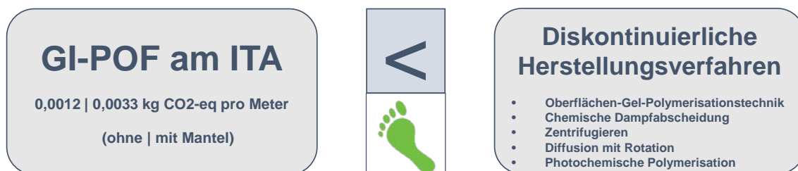
Abbildung 2.18: Qualitativer Vergleich des CO 2 -Fußabdrucks von GI-POF nach dem neuartigen Fertigungsprozess und aus diskontinuierlichen Verfahren (vgl. [www15a]).
