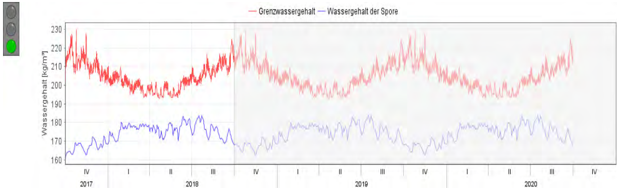
Bild 17: Berechnungsergebnis von WUFI®-Bio für den unrenovierten Plattenbau in Sofia bei verlustig gegangener EPS-Dämmung, unter Verwendung der berechneten Randbedingung an der Innenoberfläche.
