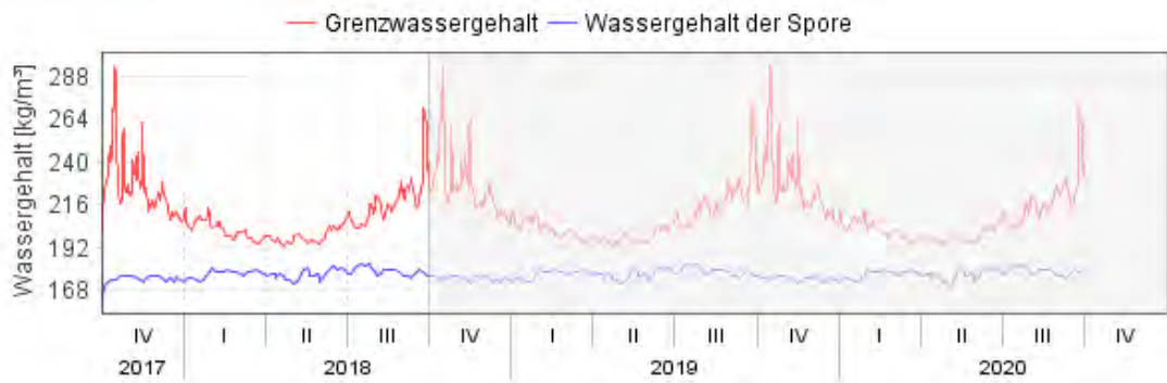
Bild 15: Berechnungsergebnis von WUFI®-Bio für die Monitorposition hinter der Dämmung des Plattenbaus in Sofia.
