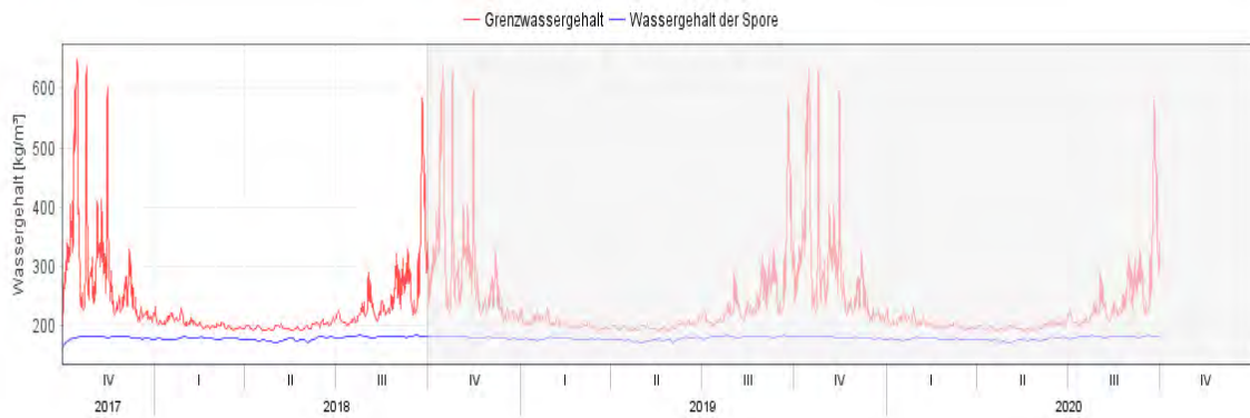
Bild 35: Berechnungsergebnis von WUFI®-Bio für das mit dem Typhaboard sanierte Schwarzmeerhaus in Varna bei Hinterströmung mit 1 \text{ m}^3/\text{m}^2\text{h} Innenraumluft.
