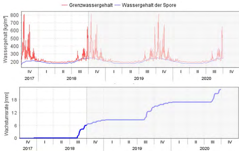
Bild 23: Berechnungsergebnis von WUFI®-Bio für den unrenovierten Plattenbau bei verlustig gegangener EPS-Dämmung in Varna unter Verwendung der berechneten Randbedingung an der Innenoberfläche. Das obere Diagramm zeigt den Verlauf des Sporenwassergehaltes im Vergleich zum Grenzwassergehalt, das untere die berechnete prognostizierte Wachstumsrate.
